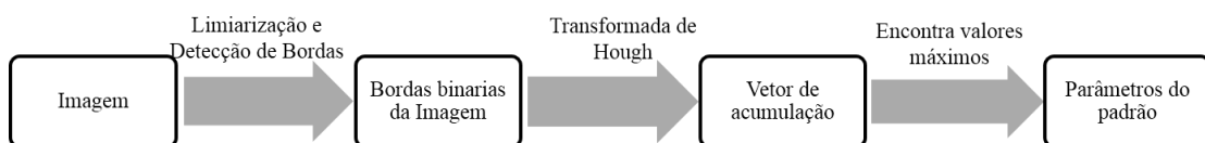
Figura 29. Sequência para aplicar a transformada de Hough.
