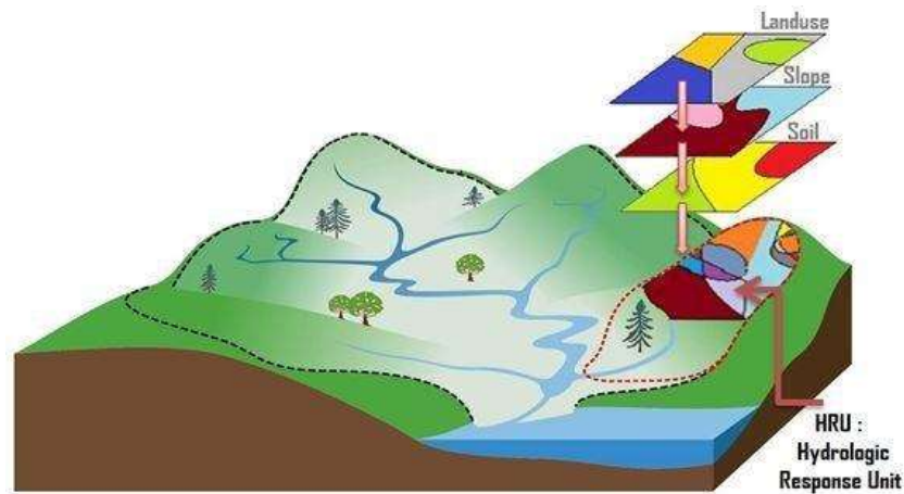
Figura 2 - Esquema da geração de HRU na bacia hidrográfica
