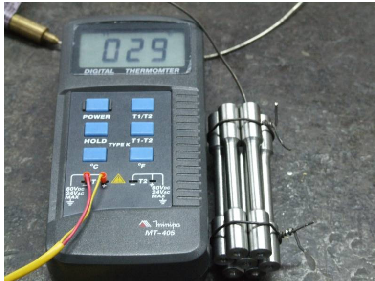
Figura 5.15 – Corpos de prova com o termopar acoplado prontos para serem colocados no forno para tratamento de têmpera e revenimento.
