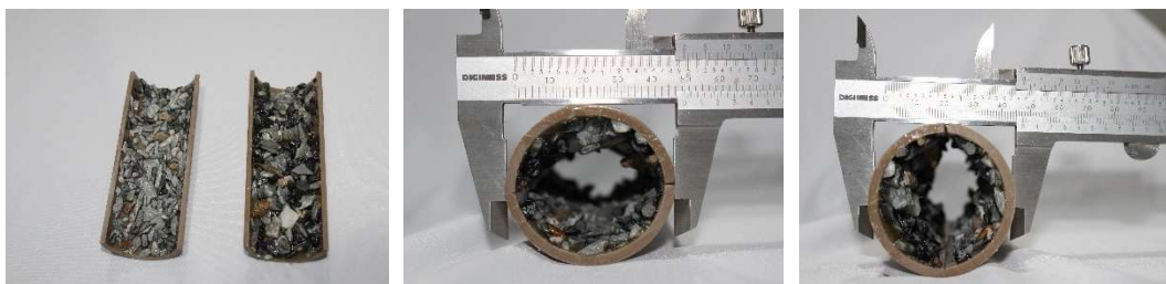
FIGURA 46 - Tubo de PVC seccionado longitudinalmente, com britas fixadas na parte interna. FONTE: PRÓPRIO AUTOR.
