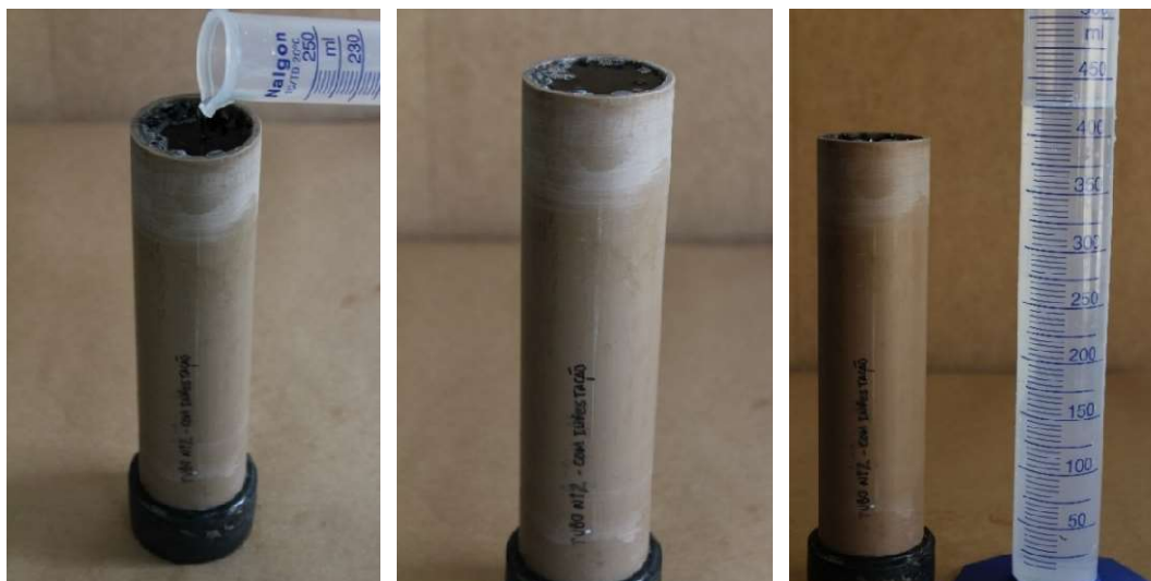
FIGURA 58 - Sequência para a medição do volume interno do conduto com britas. FONTE: PRÓPRIO AUTOR.
