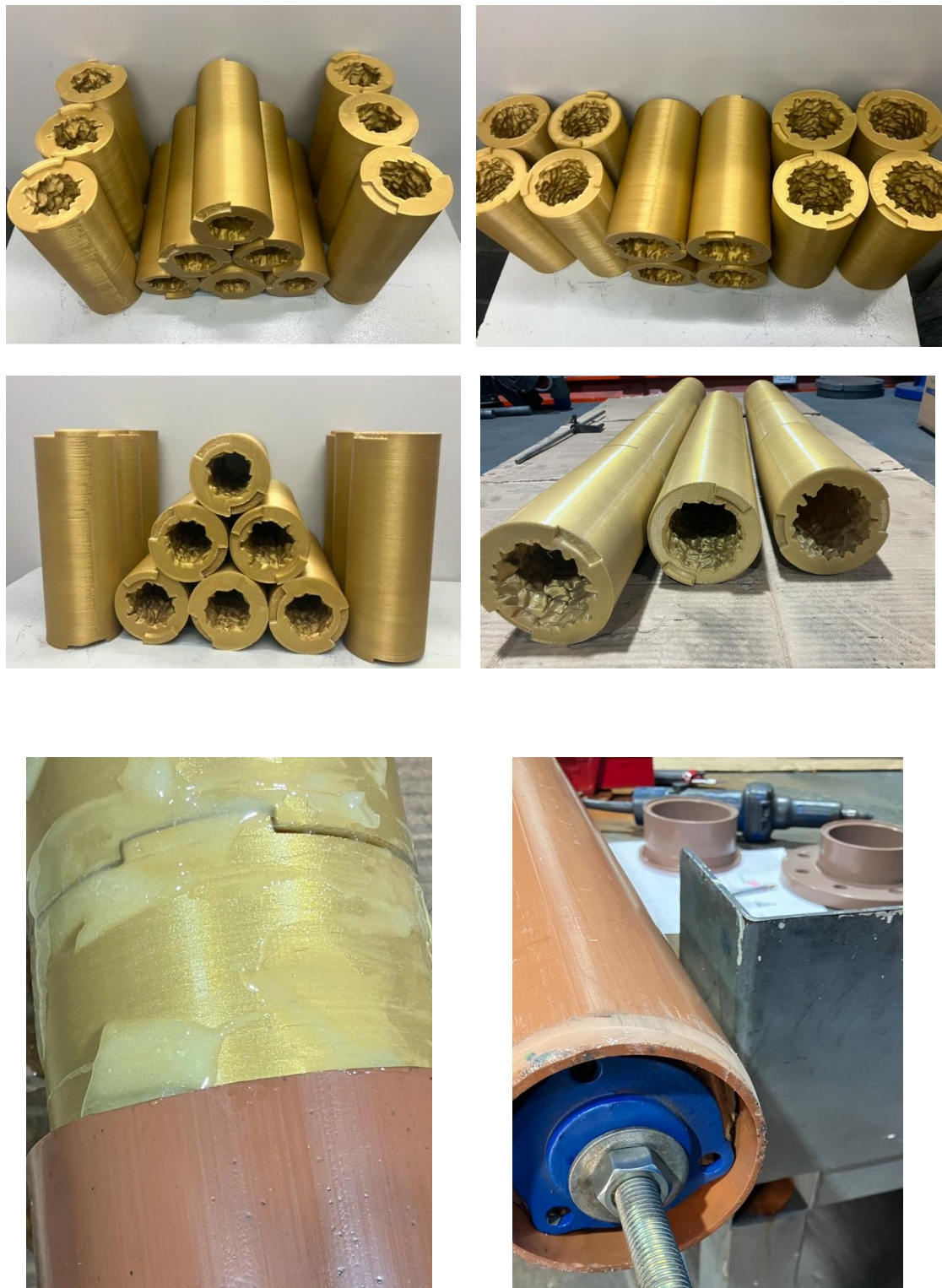
FIGURA 71 - Sequência dos elementos impressos em 3D e a montagem nos tubos de PVC. FONTE: PRÓPRIO AUTOR.
