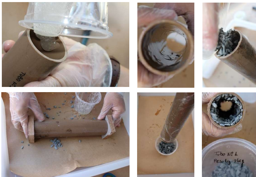
FIGURA 50 - Sequência do procedimento de fixação das britas em tubo PVC soldável de 60. FONTE: PRÓPRIO AUTOR.
