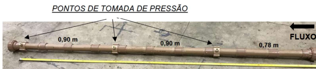
FIGURA 55 - Conduto de teste com os pontos de tomada de pressão. FONTE: PRÓPRIO AUTOR.
