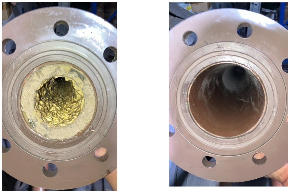
FIGURA 72 - Interior dos tubos de teste e controle montados. FONTE: PRÓPRIO AUTOR.
