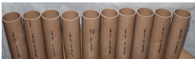
FIGURA 47 - Tubo de PVC soldável cortados com 250 mm de comprimento. FONTE: PRÓPRIO AUTOR.
