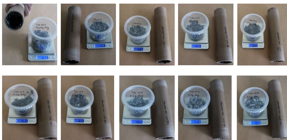
FIGURA 51 - Pesagem das britas para cada tubo de PVC soldável de 60 mm. FONTE: PRÓPRIO AUTOR.
