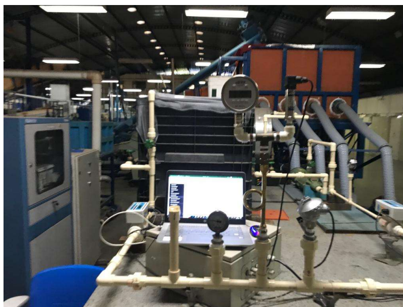
FIGURA 61 - Calibração dos transdutores de pressão. FONTE: PRÓPRIO AUTOR.
