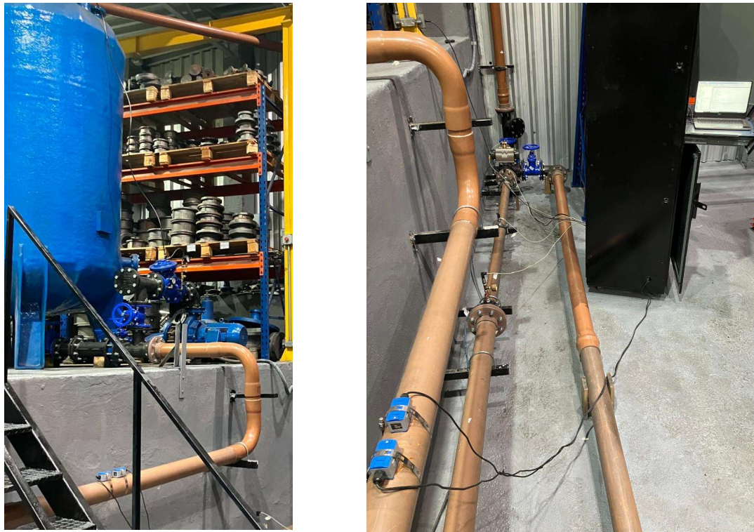
FIGURA 73 - Reservatório, linha de fluxo inicial da bancada de testes, linha de testes contendo o medidor de vazão, sensores de pressão, válvula pneumática, válvula de controle de vazão e um dos condutos de teste.
