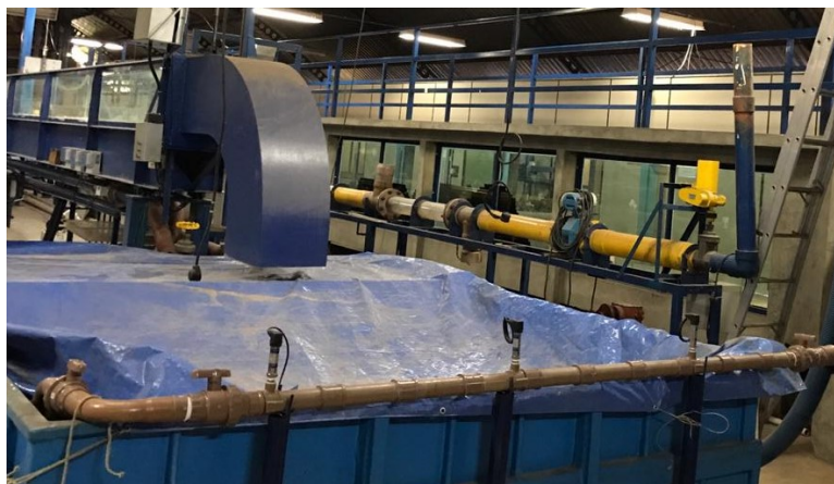
FIGURA 56 - Tubo de testes montado no CPH/UFMG. FONTE: PRÓPRIO AUTOR.
