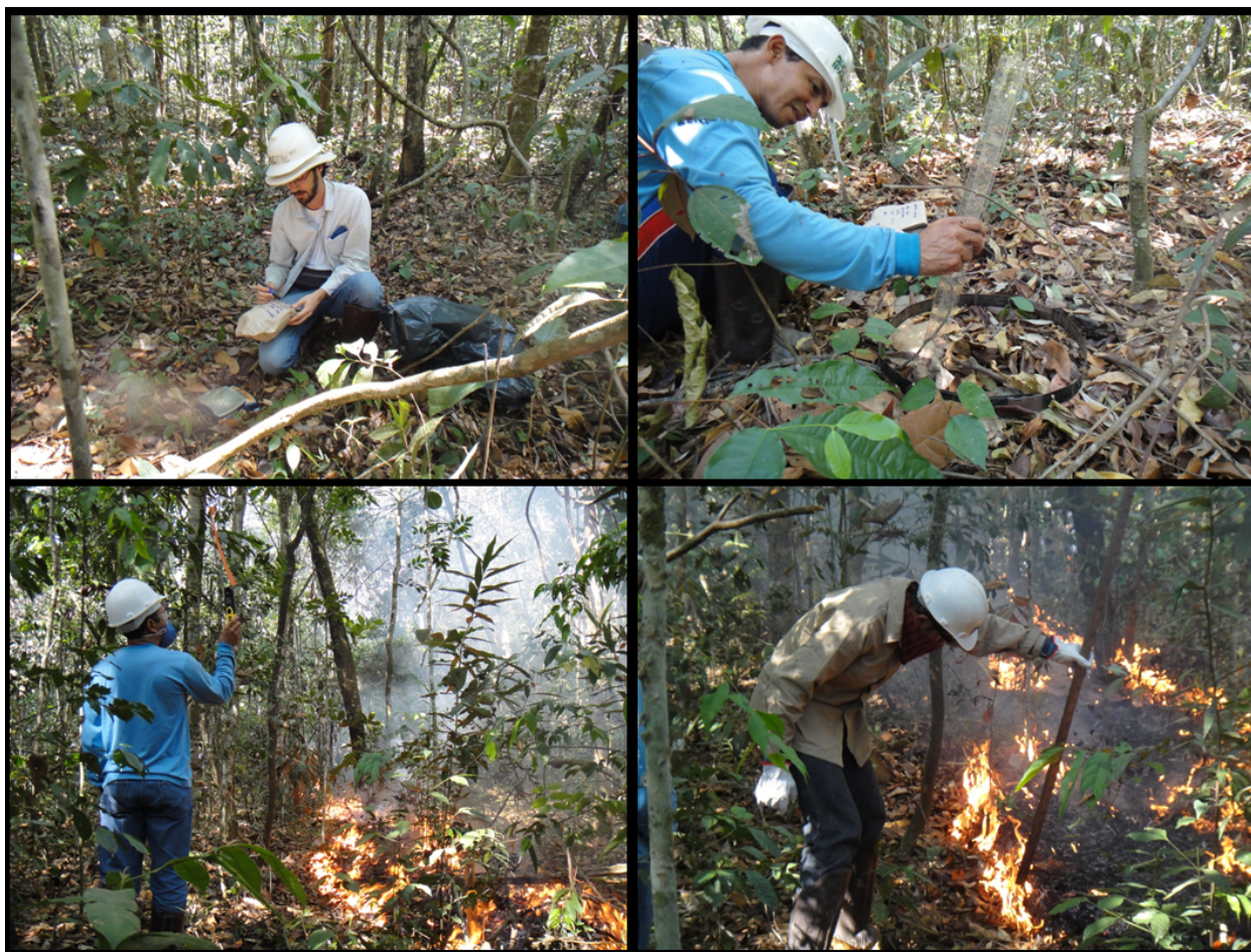
Figura S3: Medidas tomadas antes e durante a ocorrência do fogo controlado. Entre as variáveis observadas estão temperatura, umidade relativa do ar, disponibilidade de combustíveis finos, velocidade do vento e altura das chamas. Também são tomadas medidas após a extinção do fogo.
