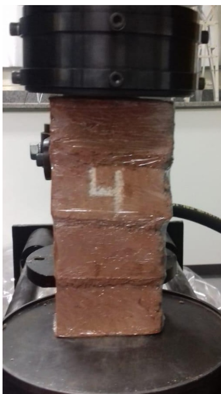
Figura 32 -Prismas posicionados para o ensaio de resistência à compressão.
