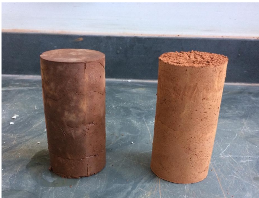
Figura 3 – Corpos de Prova após secagem, com adição de cinzas (esquerda) e sem (direita).
