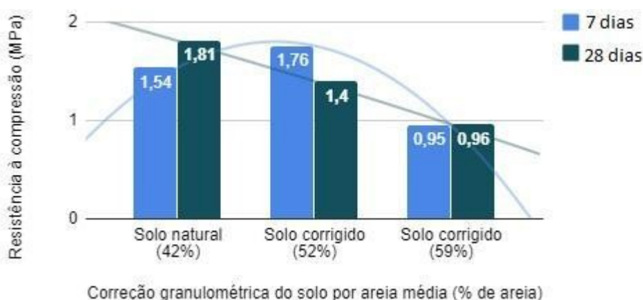
Figura 14 - Linhas de tendência da variação da resistência à compressão média para as diferentes misturas de solo sem e com correção granulométrica para 7 e para 28 dias.
