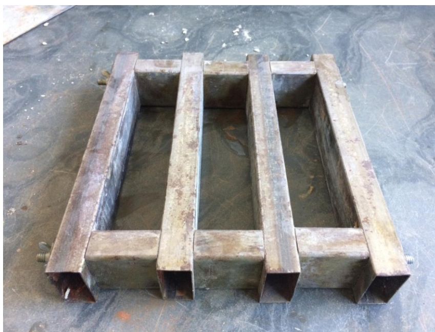
Figura 4 – Forma para moldagem dos tijolos.
