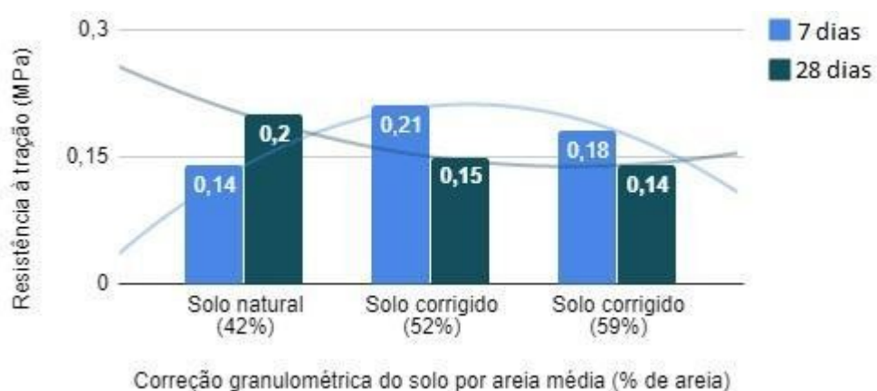
Figura 18 - Linhas de tendência da variação da resistência à tração média para as diferentes misturas de solo sem e com correção granulométrica para 7 e para 28 dias.
