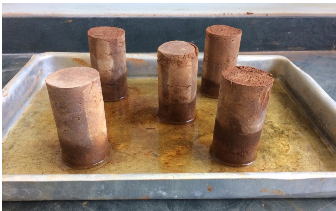
Figura 23 – Ensaio de absorção por capilaridade em CPs com adição de cinzas.
