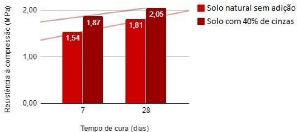
Figura 27 - Resistência à compressão média para as diferentes adições de cinzas vegetais em solo em estado natural e com 7 e 28 dias.
