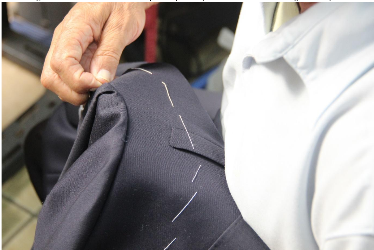
Figura 38 Uma das várias costuras que compõem o processo de encaixe da manga em um paletó
