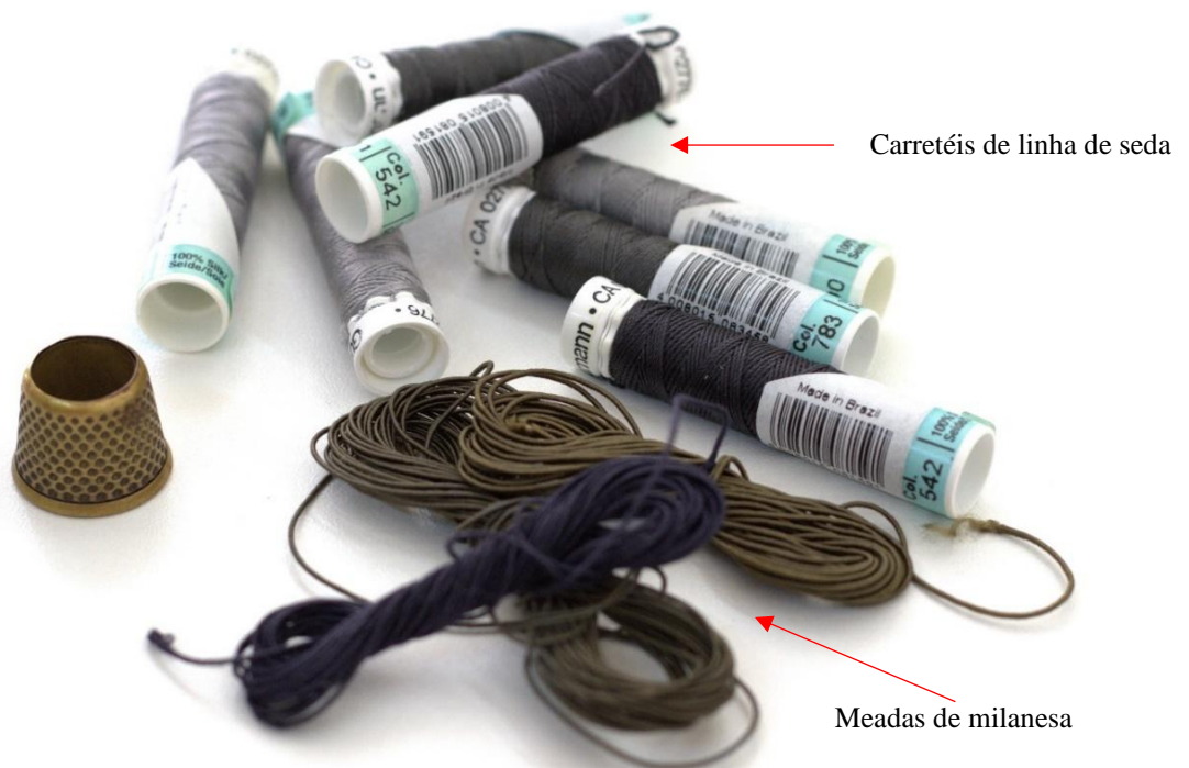
Figura 4 Dedal de alfaiate, linhas de seda para casear Gütermann e meadas de milanesa.
