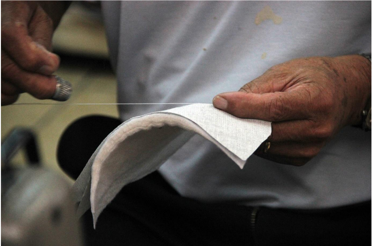
Figura 8 O preparo de uma ombreira de paletó, fixado à uma entretela e posteriormente moldado por pontos à mão obtendo então, a curvatura do ombro.
