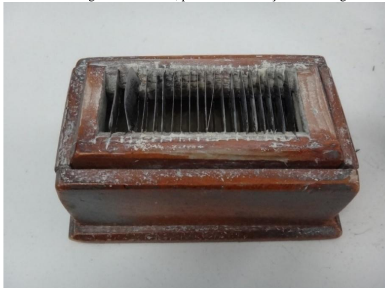
Figura 27 Afilador de giz com lâminas, para manter o traçado fino do giz de alfaiate.
