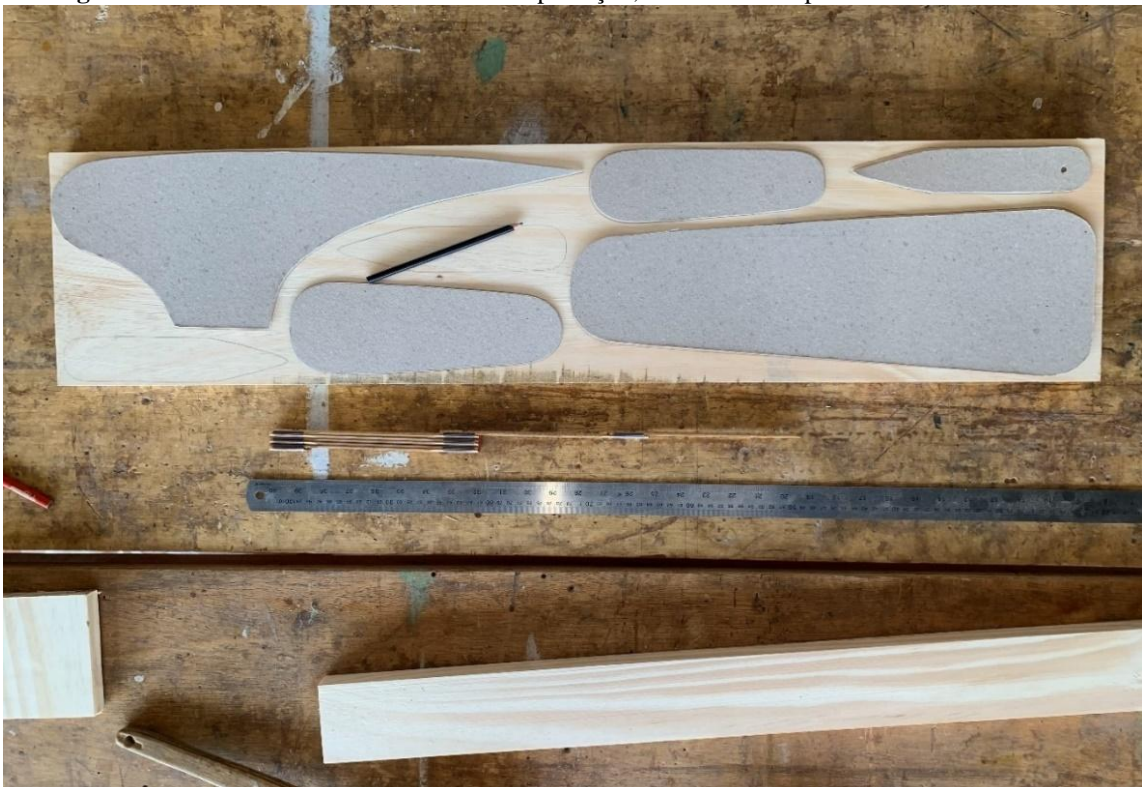
Figura 17 Plano de corte de instrumentos de passagem, semelhante ao processo do corte de tecido
