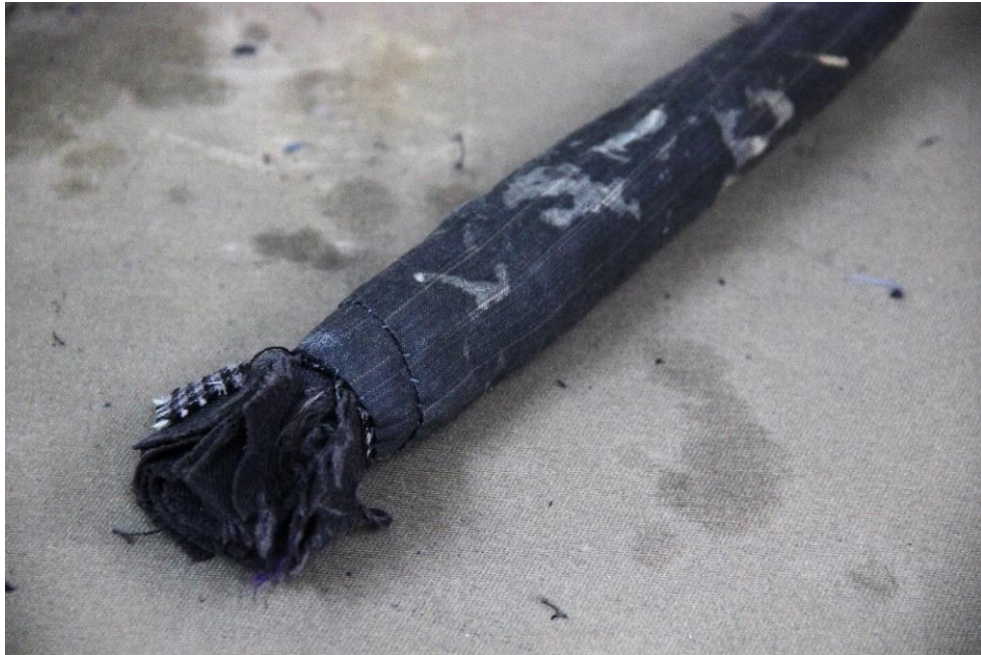
Figura 19 Pincel feito com retalhos, para ajudar no processo de umidificação das entretelas e do próprio tecido, utilizado como auxiliar do ferro de passar.
