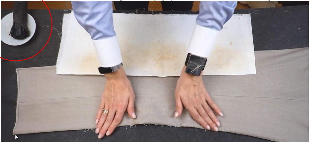
Figura 21 Encolha na frente da perna da calça, projetando o movimento natural do corpo.
