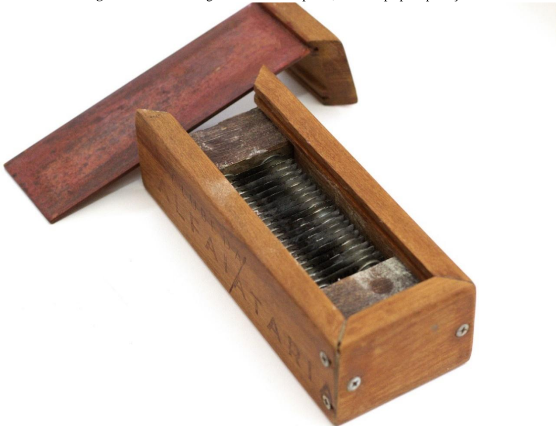
Figura 28 Afilador de giz de alfaiate adaptado, com tampa para proteção.
