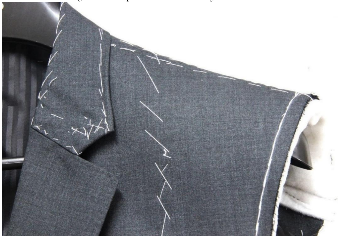
Figura 30 Gola aplicada a mão em seu estágio final de acabamento
