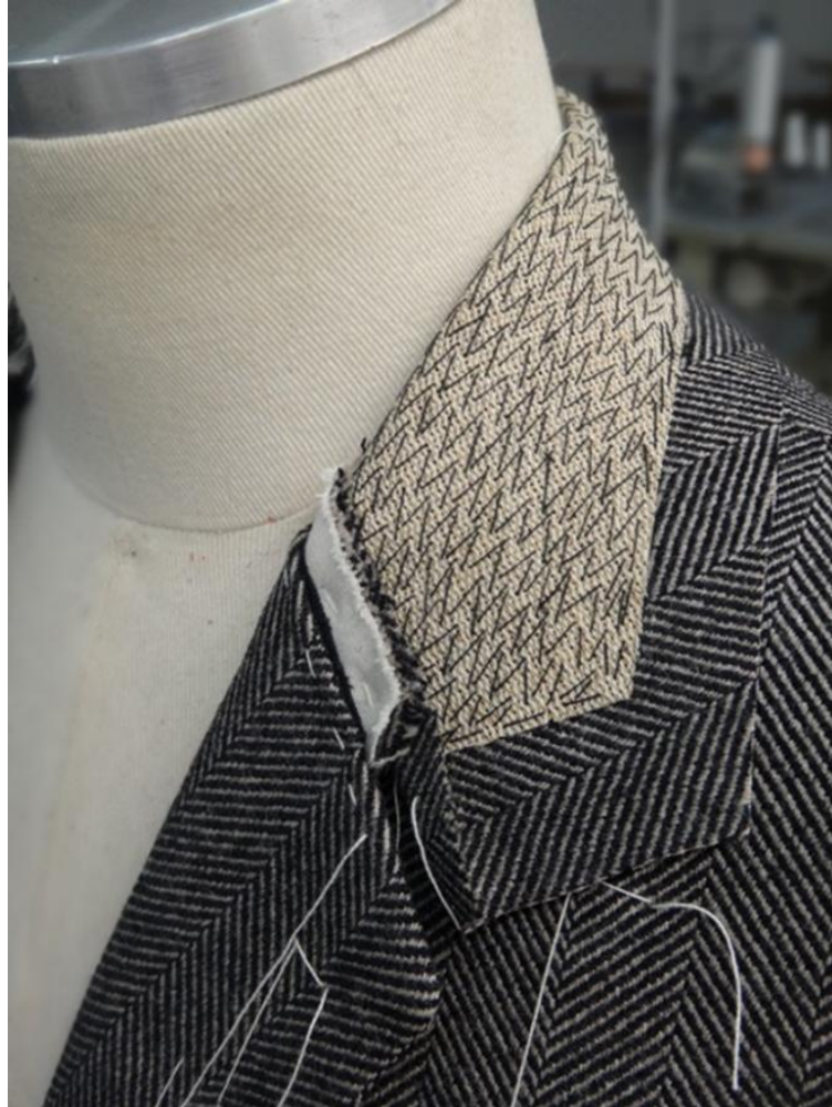
Figura 40 Baixo da gola aplicado ao paletó, produzido com entretela de linho
