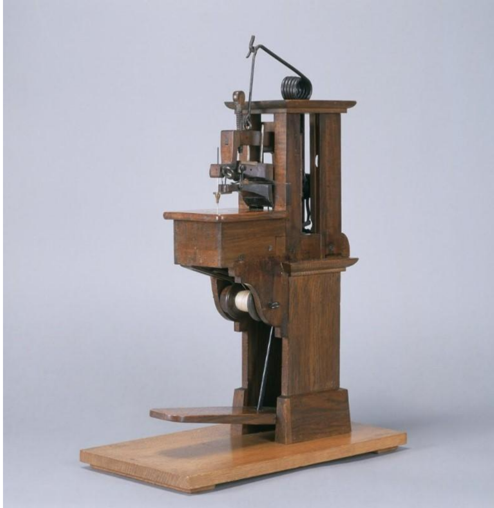
Figura 29 “Tear de costura” de Thimonnier, predecessora das máquinas de costura domésticas
