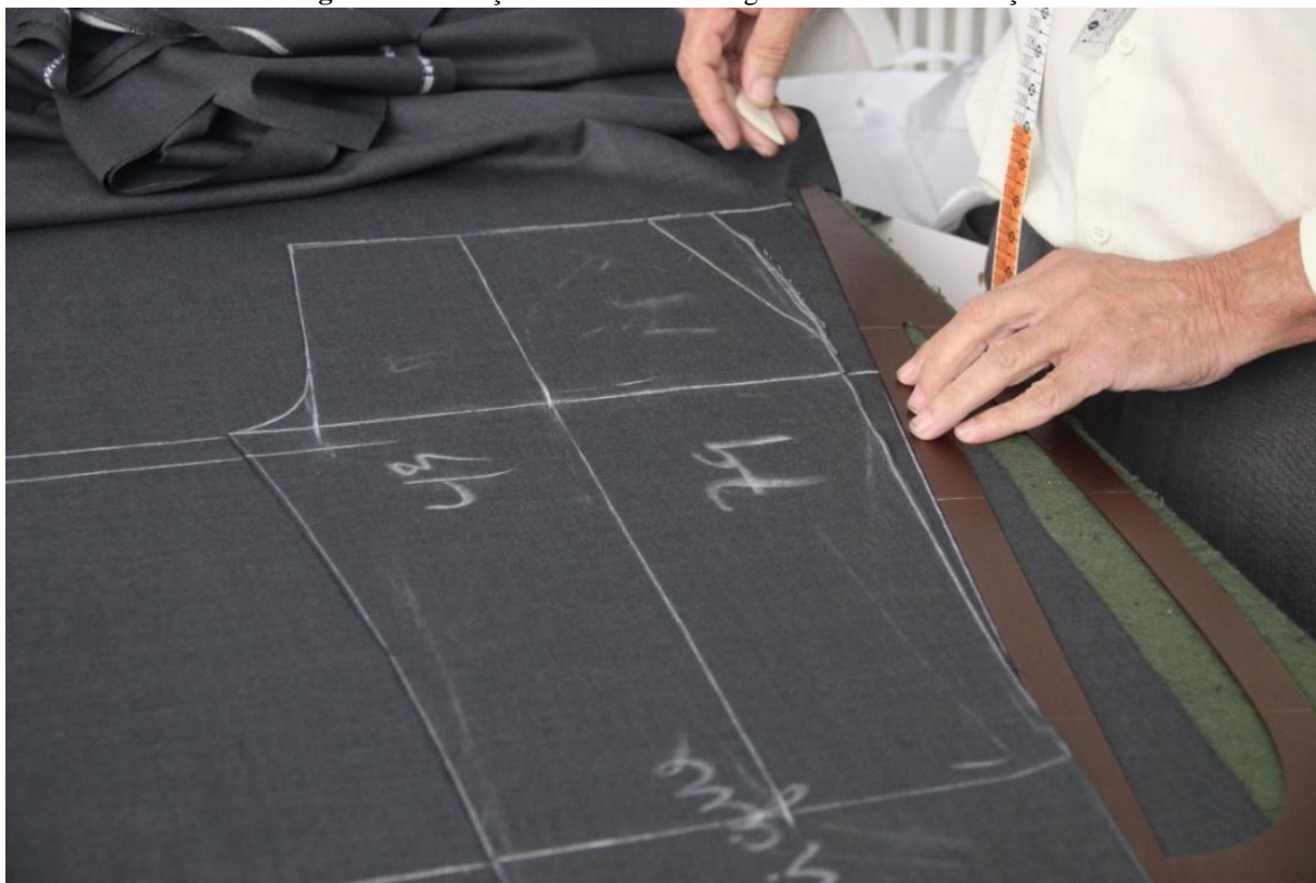
Figura 36 Anotações de medidas com giz em um corte de calça
