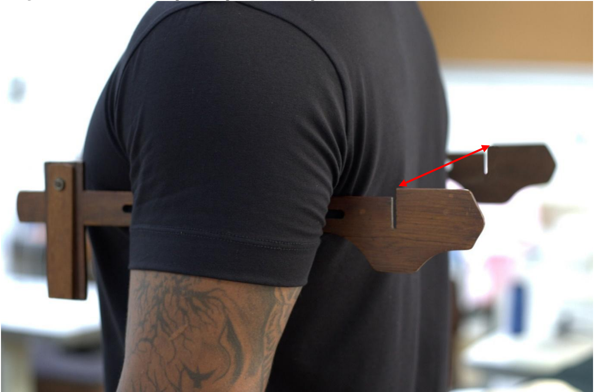
Figura 26 Posicionamento do pêndulo (prumo de cava) para a tomada da medida de entre cavas nas costas.
