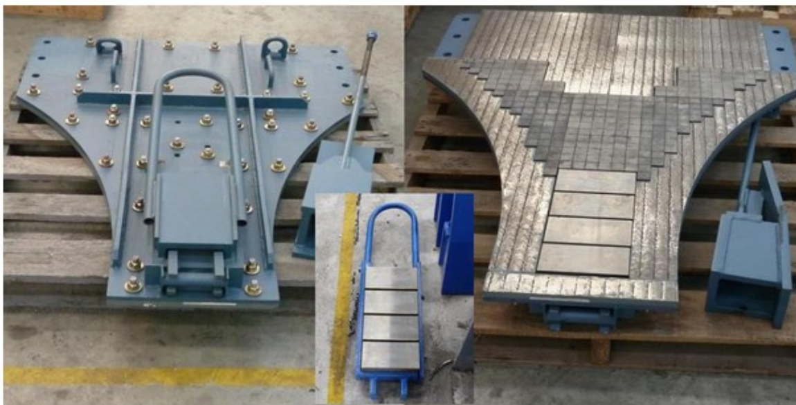
Figura 9 - Cheekplate com revestimento novo instalado
