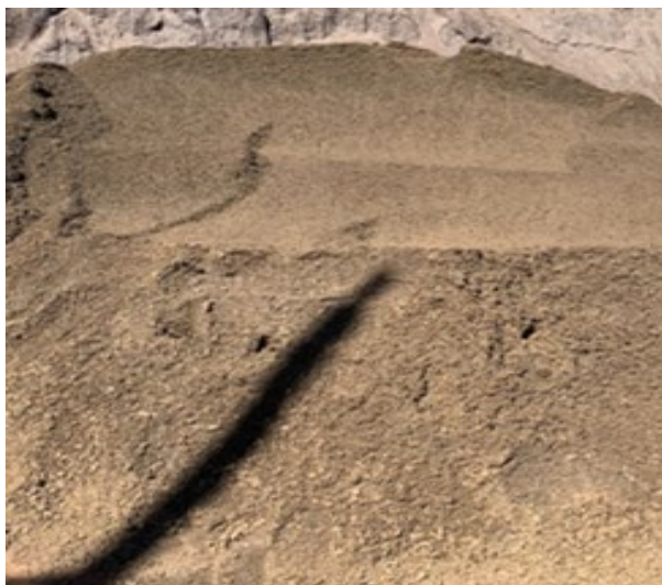
Figura 31- Silo Sínter – após perda de umidade 9,0%
