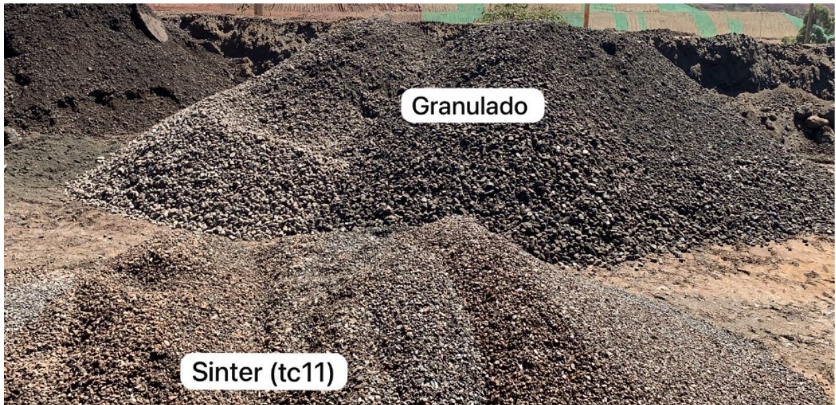
Figura 39- Origens: Silo de Granulado e SF grosso da TC-11
