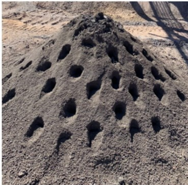
Figura 34 - Silo Sínter – após perda de umidade 9,0%
