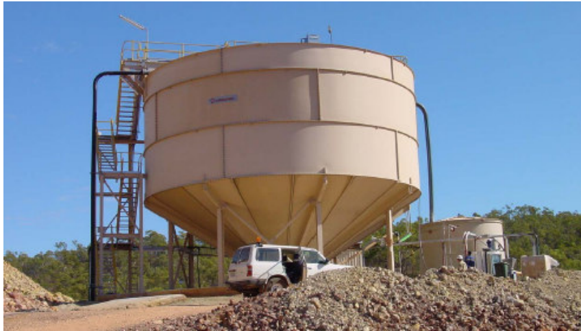
Figura 1.2: Exemplo de um espessador de pastas. (Fogwill, 2005)
