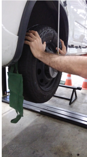
Figura 20 – Posicionamento da massa padrão para medição
