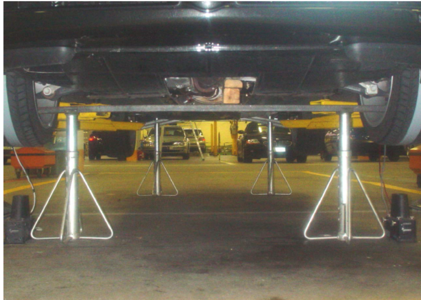
Figura 17 – Suporte do veículo sobre cavaletes
