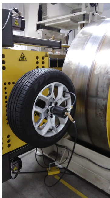
Figura 25 – Dinamômetro de resistência ao rolamento
