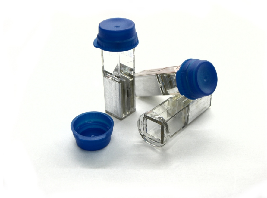
Figura 7 – Cubeta para eletroporação. Fonte: [43]
