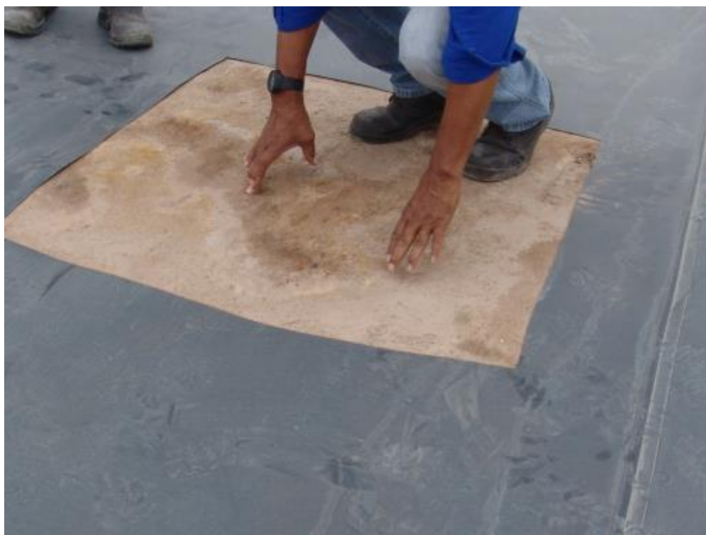
Figura 3-13 – Lago II – Exumação da amostra de GM de PVC
