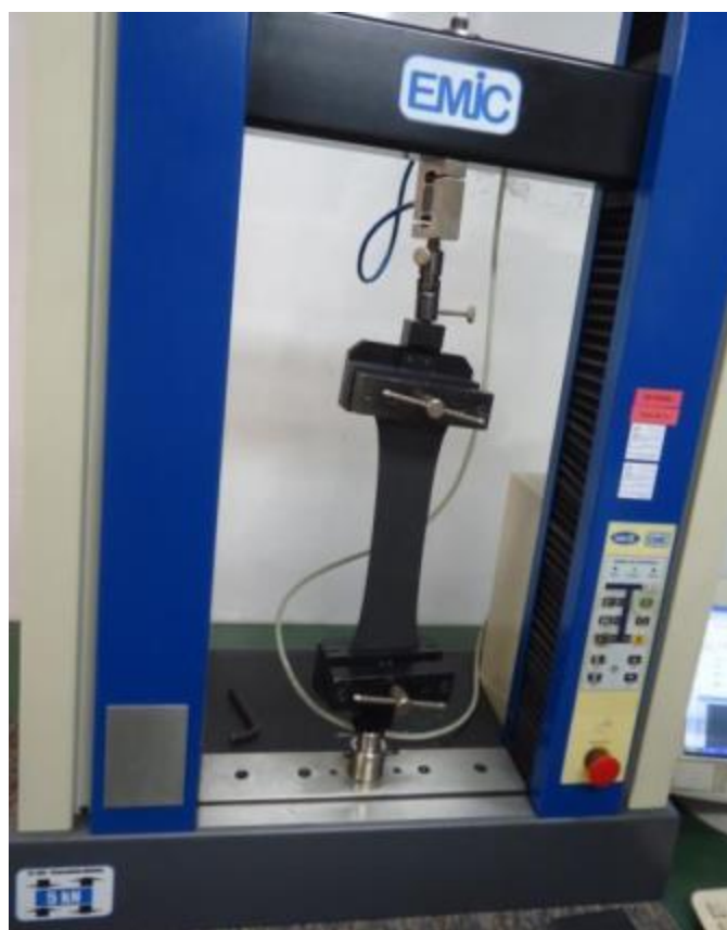
Figura 2.6 – Ensaio de tração em geomembrana de HDPE
