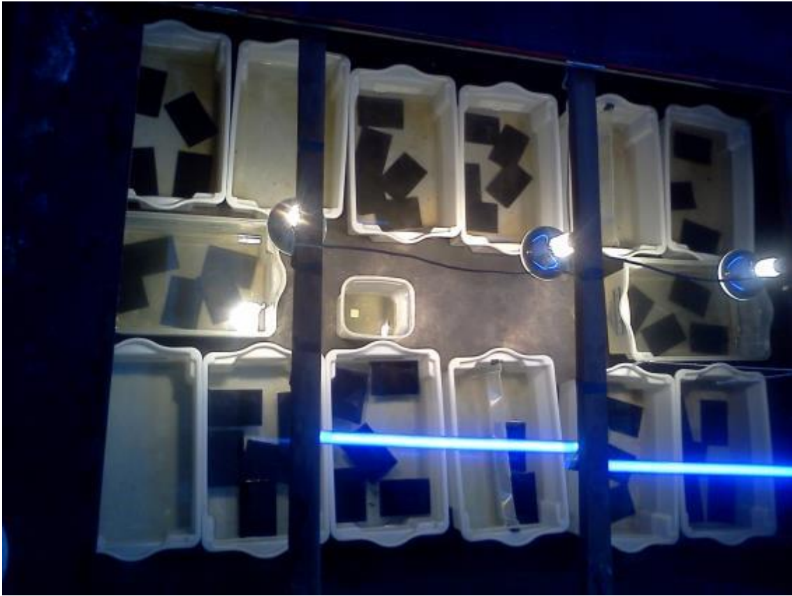
Figura 3-32–Imersão das amostras no fluido cianetado para ensaios de durabilidade.
