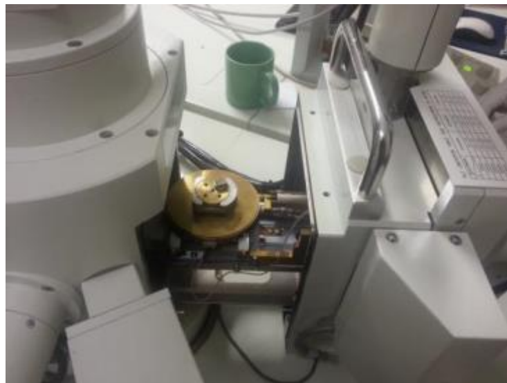
Figura 3-43 – Câmara da amostra com mesa para fixação dos suportes metálicos.
