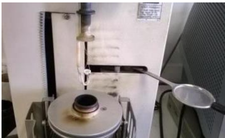
Figura 3-41-Detalhe do forno e cadinho
