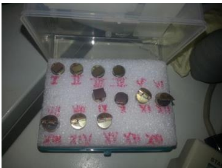
Figura 3-44 – Amostras metalizadas com ouro
