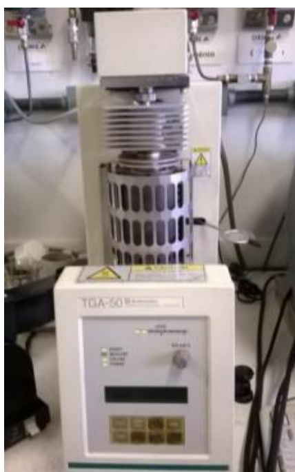
Figura 3-40 - Equipamento de termogravimetria
