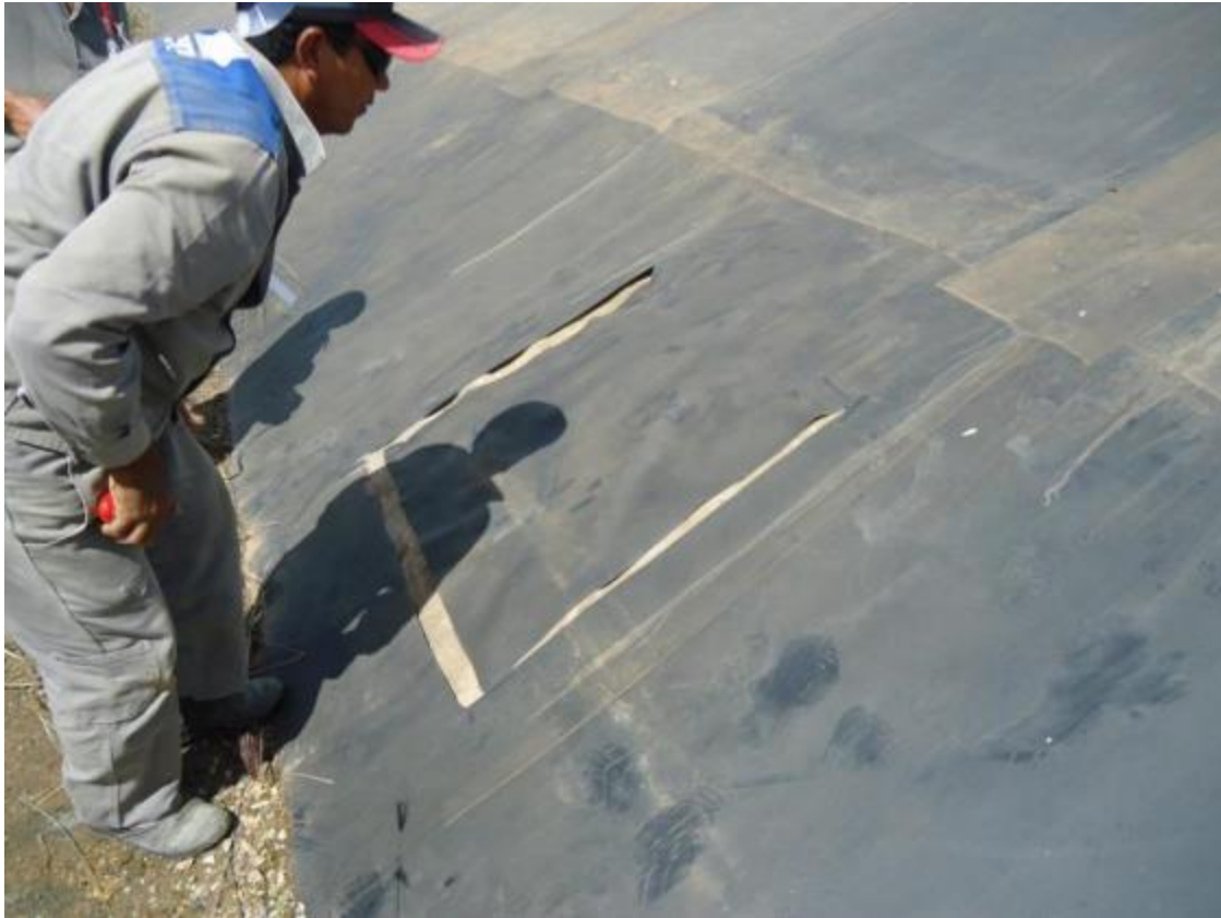
Figura 3-29 – Lago II – Exumação amostra de PVC
