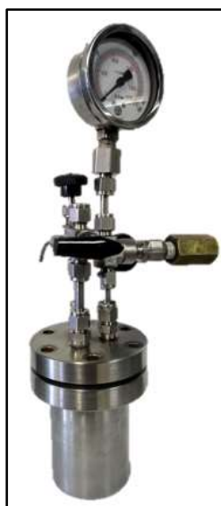
Figura 3.12: Foto da autoclave utilizada nos testes catalíticos realizados a pressões superiores a 1 atm.
