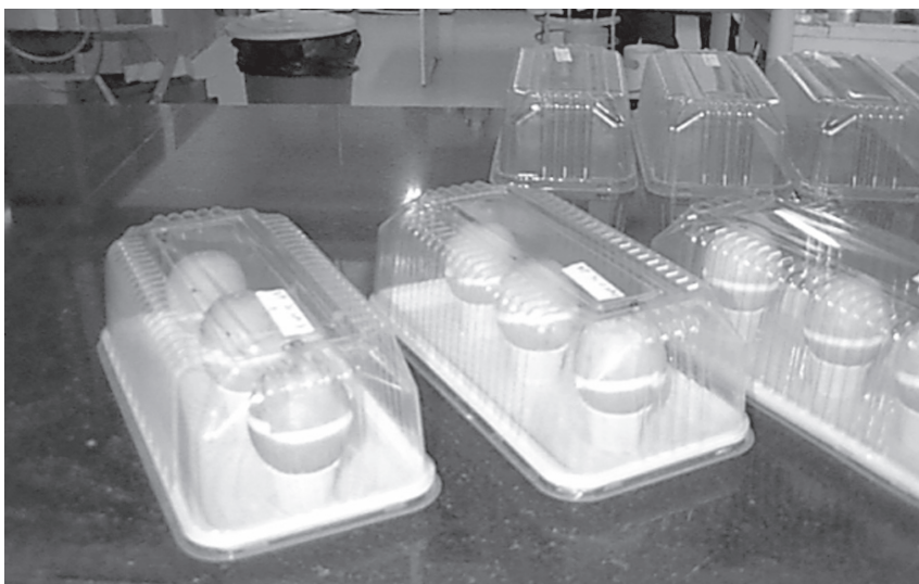
FIGURA 2: Aparato para incubação de laranjas inoculadas com patógenos do ar. Note o suporte (copo de café descartável) na base de um recipiente plástico (caixa descartável de plástico). O recipiente deve conter água em sua base
