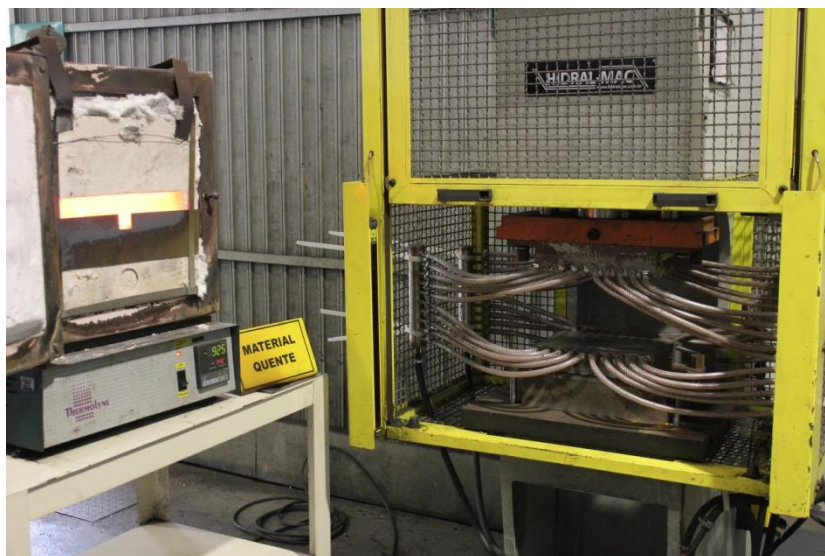
Figura 4.3 – Prensa com matriz e molde refrigerados a água utilizada para o processo de estampagem a quente piloto.
