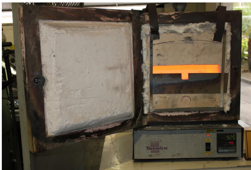
Figura 4.1 – Forno tipo mufla a ser utilizado para os tratamentos térmicos de austenitização no estudo.
