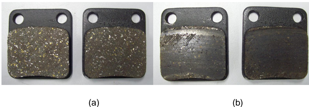
Figura 4.3: Pastilha de freio “nova” antes (a) e após o assentamento (b).
