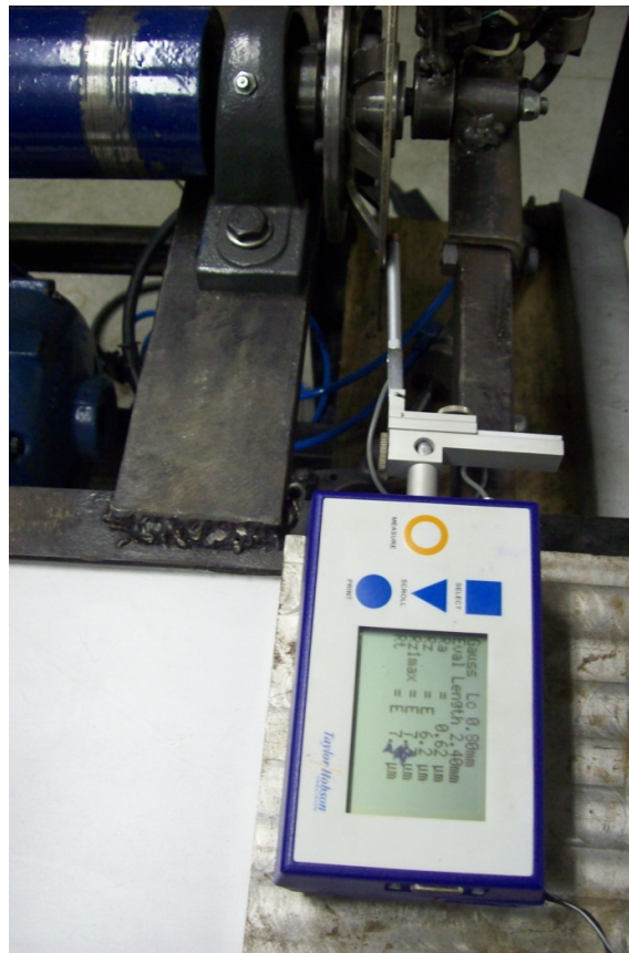
Figura 4.1: Procedimento para inspeção da rugosidade do disco de freio.
