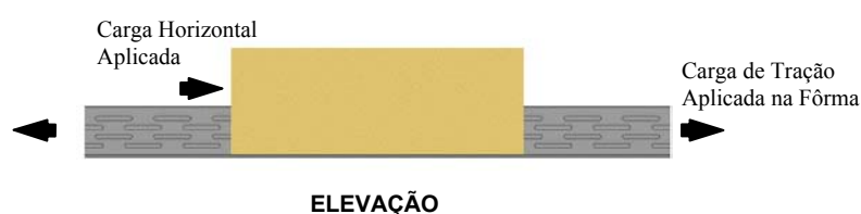
FIGURA 6.9 - Ensaio em pequena escala da laje mista com tração na fôrma - tension-push test
