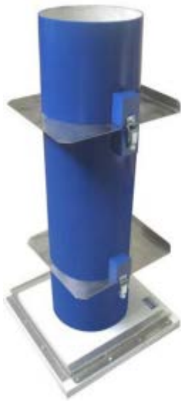
Figura 2.13: Prescreve o ensaio para determinação da resistência á segregação do concreto, pela diferença das massas de agregado graúdo existentes no topo e na base da coluna de segregação.
