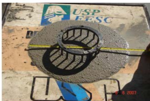
Figura 2.5: O ensaio tenta simular as armaduras de uma estrutura real, para verificação da fluidez e da habilidade do concreto passar por obstáculos. Fonte: Inês Laranjeira da Silva Battagin, 2º Fórum Mineiro de Estruturas de Concreto (11/2012)
