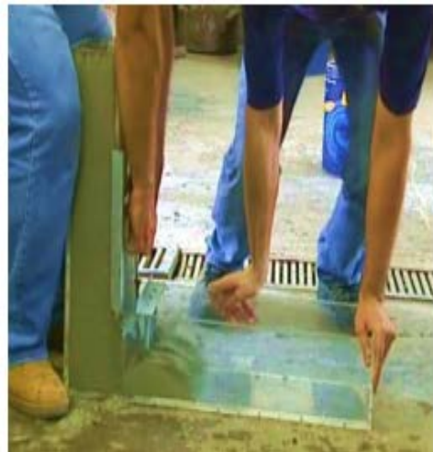
Figura 2.8: Esquema habilidade passante em fluxo confinado do concreto auto-adensável usando a caixa L.
