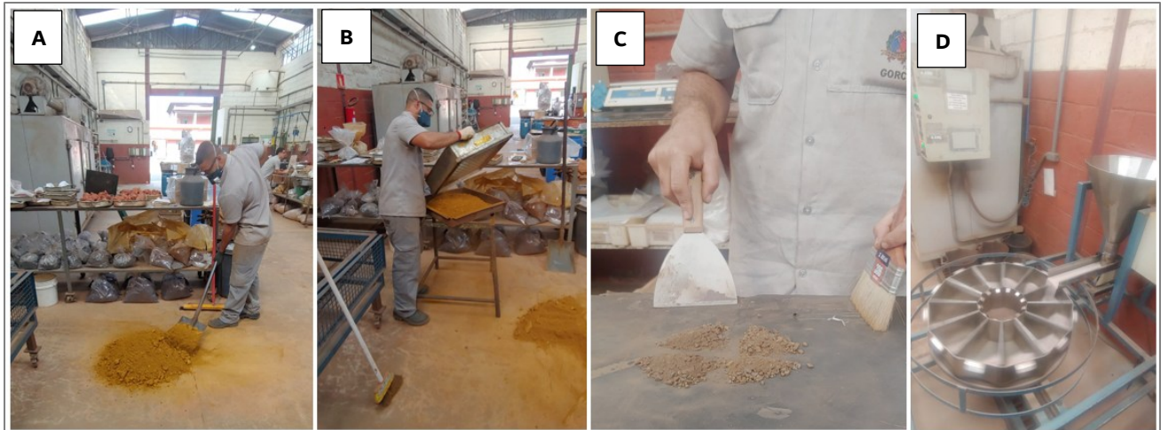
Figura 13. Preparação física das amostras na Fundação Gorceix: A) Homogeneização; B) Peneiramento e classificação; C) Quarteamento manual e D) Quarteamento automatizado. Imagens da autora.
