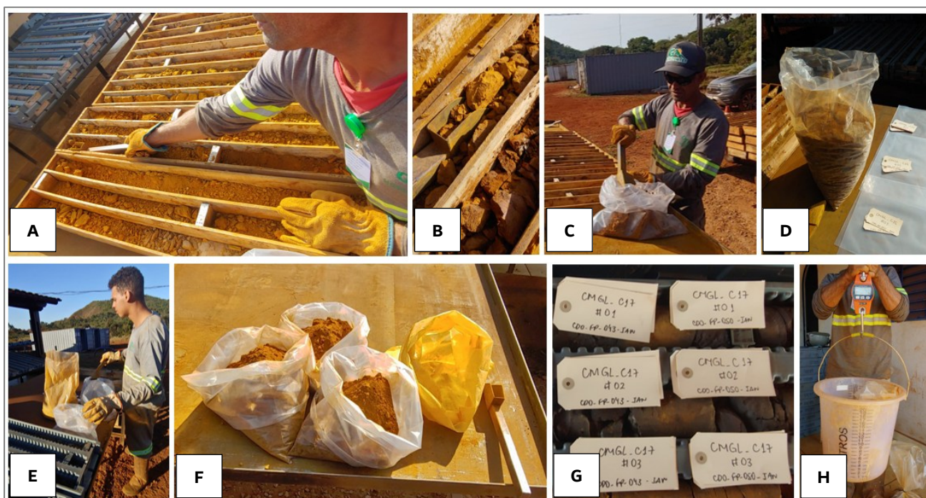
Figura 12. A), B) e C) Amostragem de \frac{1}{4} dos intervalos dos testemunhos selecionados, por intervalo; D) Amostra de um intervalo completo; E) e F) Separação da amostra de um intervalo completo em três alíquotas iguais; G) Confecção das etiquetas; H) Pesagem das alíquotas individualmente. Imagens da autora.
