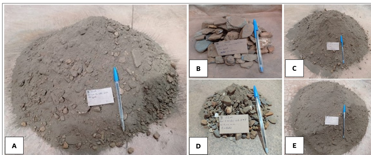
Figura 16. Preparação das amostras do Cluster 06: A) Formação da pilha para homogeneização e quarteamento do ROM global tal qual; B) Fração >16,0\text{mm} natural originada do peneiramento do ROM global tal qual; C) Fração <16,0\text{mm} natural originada do peneiramento do ROM global tal qual; D) Fração >16,0\text{mm} natural britado em 100% abaixo de 16,0mm; E) Blend global <16,0\text{mm} ( +16,0\text{mm} britado e -16,0\text{mm} natural). Fonte das imagens: Fundação Gorceix.
