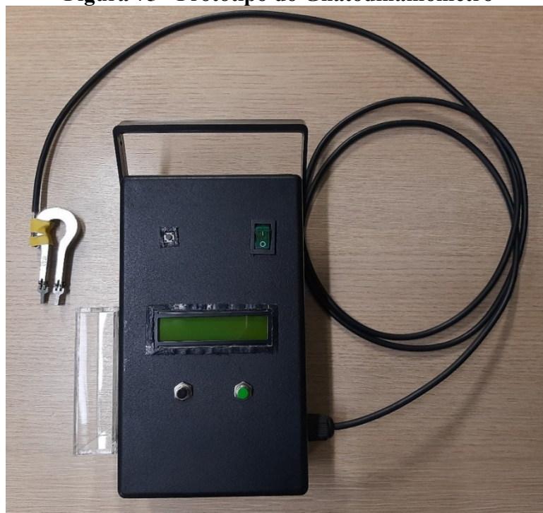
Figura 75 - Protótipo do Gnatodinamômetro
