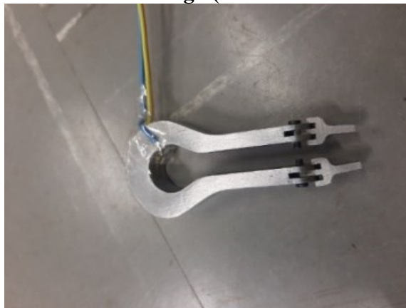
Figura 63 - Célula de carga (sem o tratamento térmico)
