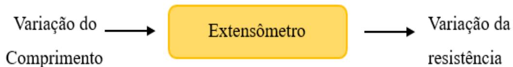
Figura 36 - Princípio de funcionamento do extensômetro de resistência elétrica
