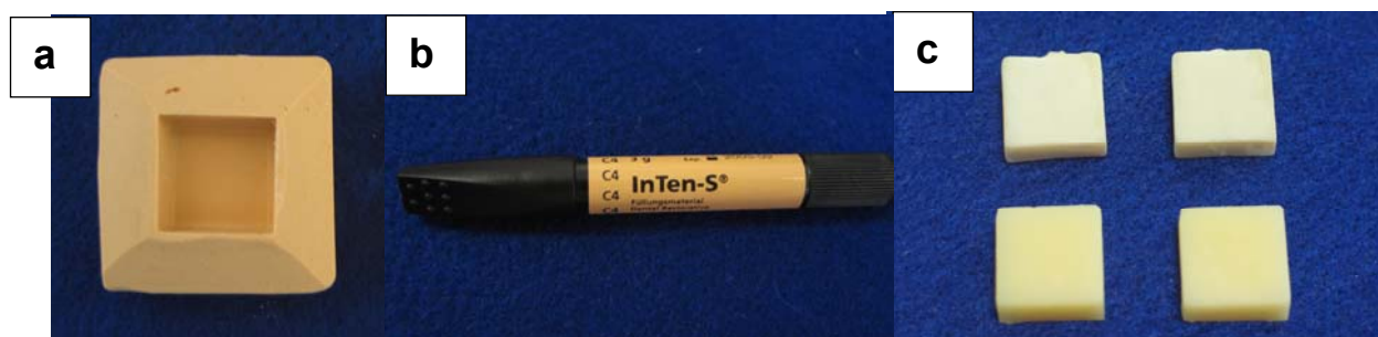
FIGURA 3: (a) Molde em polivinilsiloxano para obtenção dos blocos de resina composta; (b) resina In Ten-S ® ; (c) blocos de cerâmica (acima) e resina (abaixo) após o acabamento.
