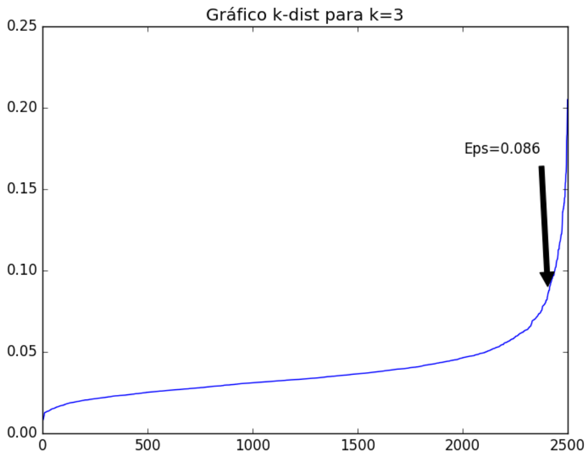
Figura 2.23: Gráfico k -dist do conjunto de dados da figura 2.22, onde o crescimento abrupto ocorre para a distância 0.086 aproximadamente.
