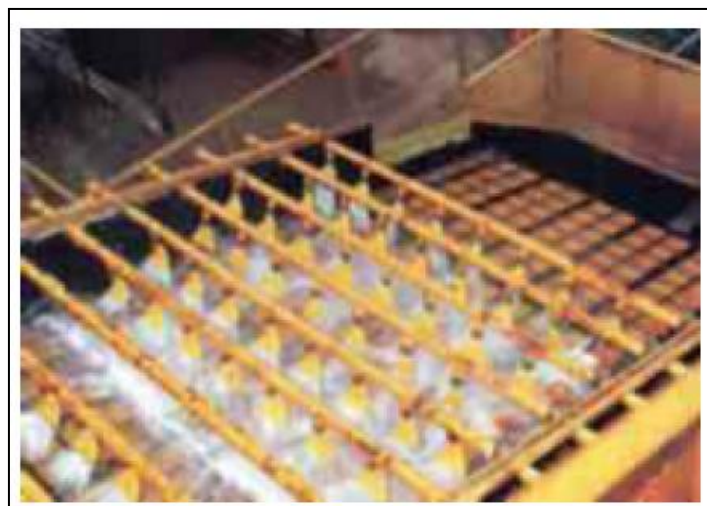
Figura 20- Sistema de aspersão de água Fonte: Metso, Handbook of Crushing, 2011
