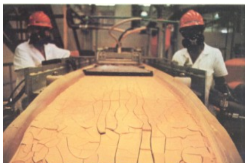
FIGURA 4.4 – Concentrado de Urânio Passando pelo Filtro antes da Secagem
