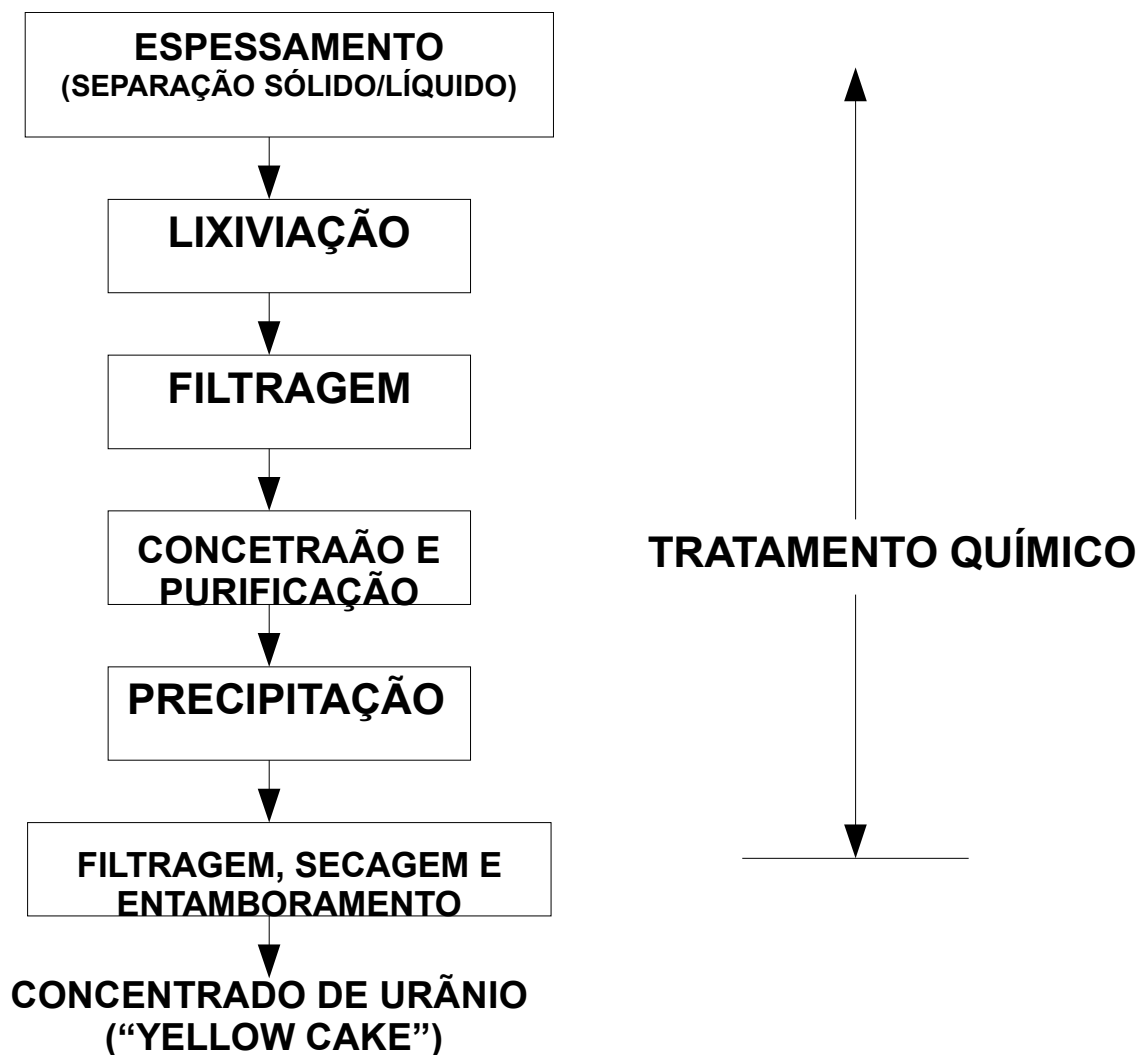
FIGURA I.2 – Diagrama Esquemático do Tratamento Químico no Processamento do Minério de Urânio
