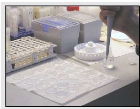
Figura 3.8. Descrição de procedimento para limpeza dos discos de quartzo utilizados como porta amostras. Fotos extraídas de Bruker, 2012.
