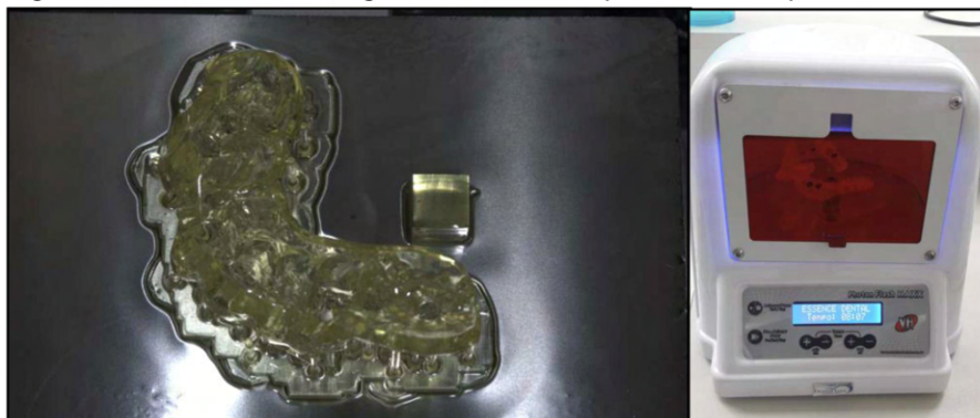
Figura 38 – Manufatura do guia através de Impressão 3D e pós-cura
