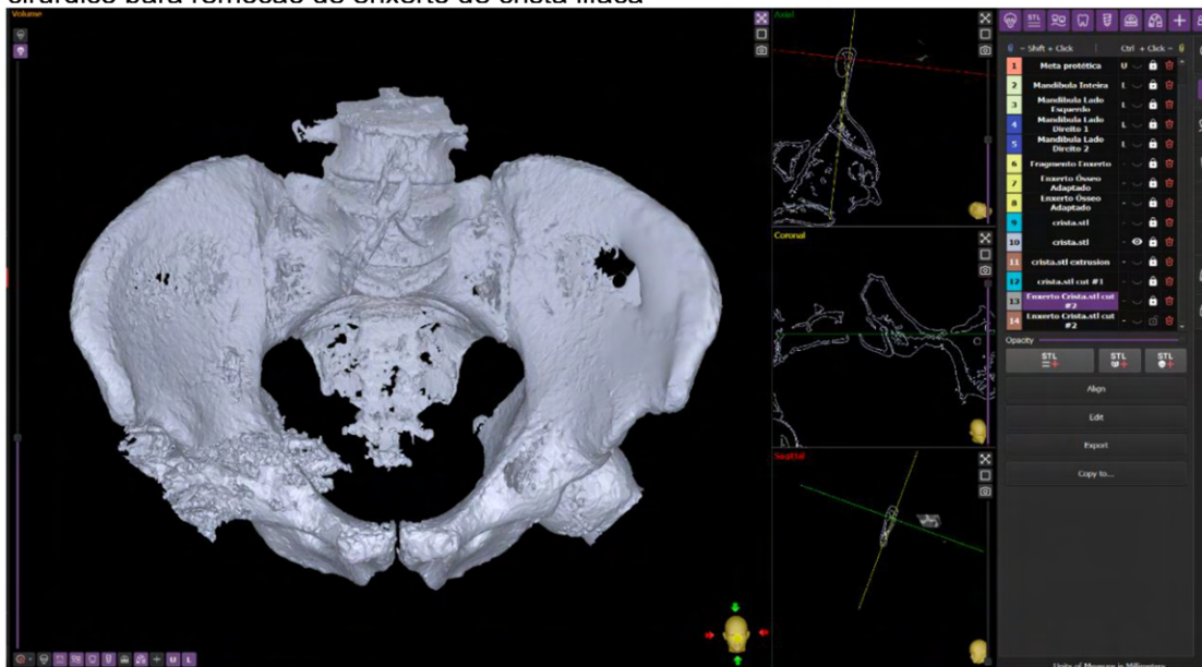
Figura 67 – Interface do software Implastation aplicado para modelagem e confecção de guia cirúrgico para remoção de enxerto de crista íliaca
