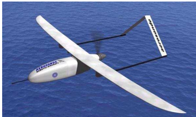
Figura 2.3: Aerosonde - VANT projetado para coleta de dados climáticos, como temperatura, pressão atmosférica e umidade.
