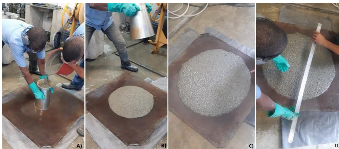
Figura 3.10 – a) CAA sendo colocado no cone; b) retirada do cone c) concreto exposto na chapa metálica d) medida do espalhamento
