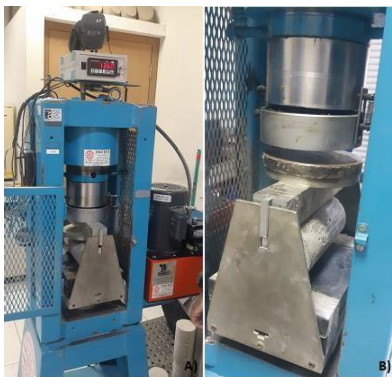
Figura 3.14 – a) Posicionamento do CP para ensaio de tração por compressão diametral; b) Detalhes do aparato para posicionamento de CP's na máquina de ensaio.
