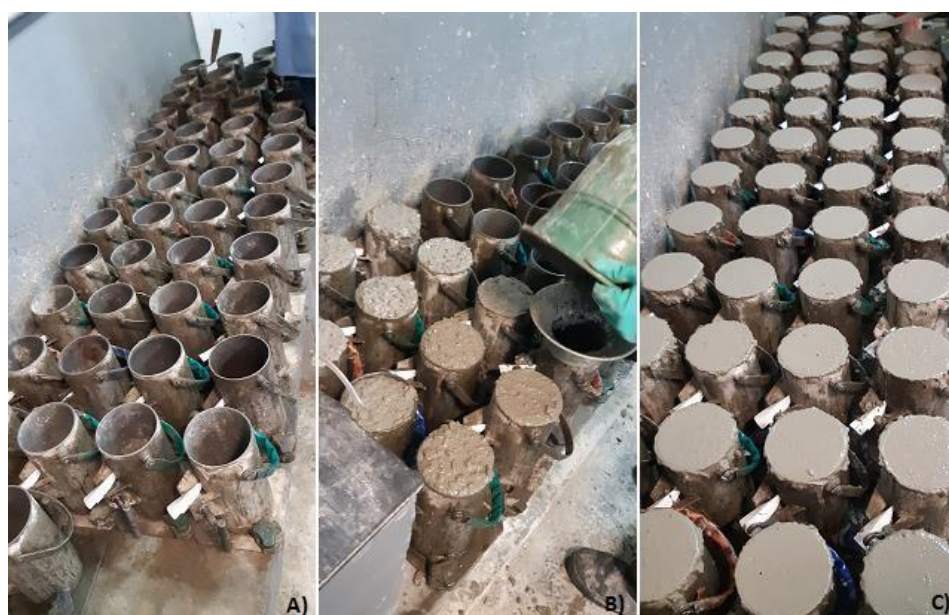
Figura 3.12 – a) Fôrmas já identificadas e com o óleo desmoldante; b) CAA sendo colocado nas fôrmas c) CAA nas fôrmas
