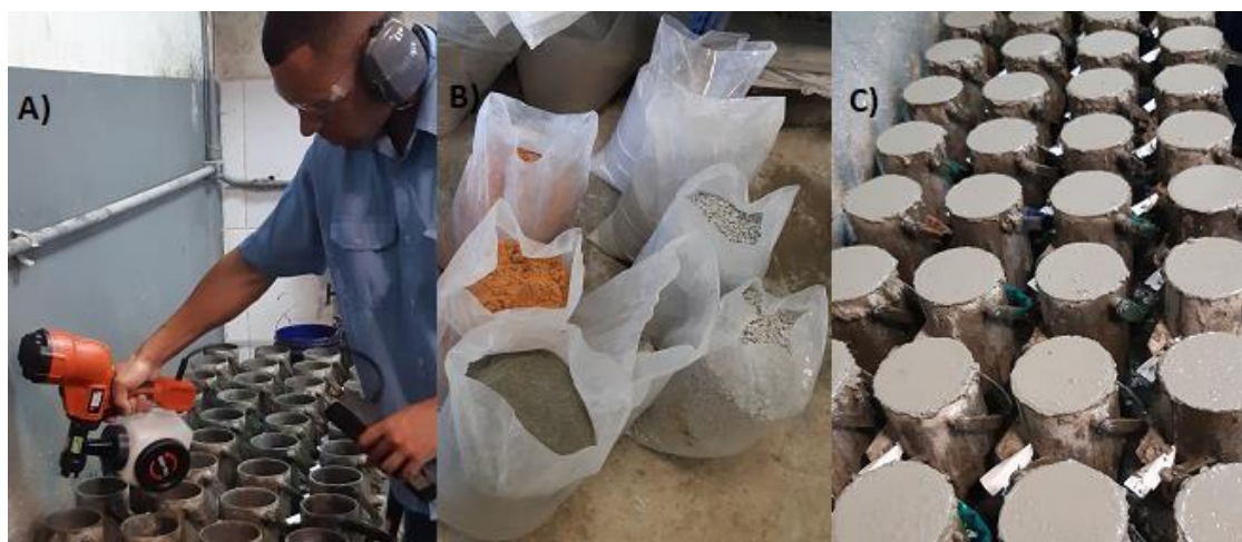
Figura 3.9 – a) lubrificação das fôrmas com óleo desmoldante; b) materiais pesados e separados; c) CAA nas fôrmas
