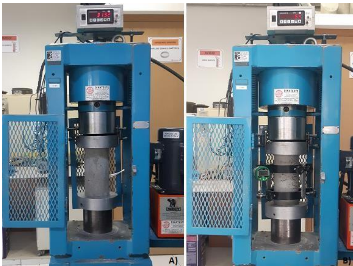
Figura 3.13 – a) Posicionamento do CP para ensaio de compressão; b) Posicionamento do CP para ensaio da relação tensão versus deformação.
