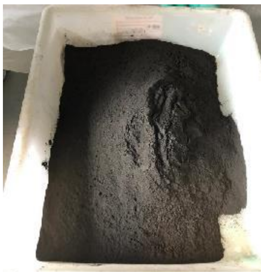
Figura 3.4 – Clínquer nanoestruturado do Lote CNT00319.
