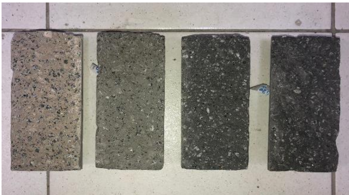
Figura 3.15 – Corpos de prova depois de rompidos (idade de 7 dias) na seguinte sequência da esquerda para a direita: CAAREF, CAANTC050, CAANTC075 e CAANTC1.
