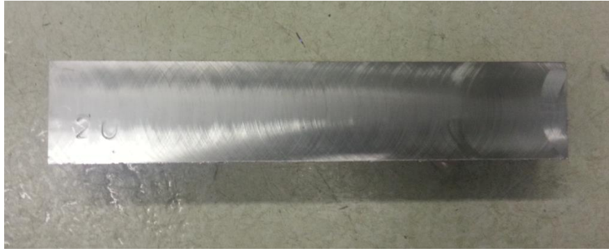
FIGURA 4.11 – Corpo de prova de aço ABNT 1010 após o ensaio de fresamento, com a respectiva identificação (próprio autor).
