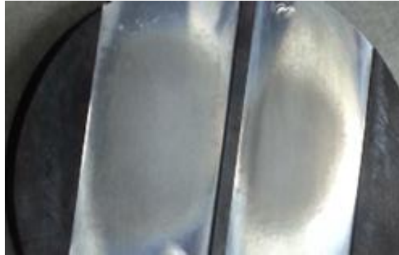
FIGURA 4.13 – Aspecto da superfície de um corpo de prova de aço ABNT 4340 após limpeza e ataque com nital a 10% (próprio autor).
