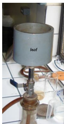
Figura 3.38 – Detalhe do leaf utilizado no teste de folha com alimentação por cima.
