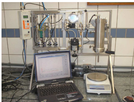
Figura 4.5 - Montagem para ensaios dos testes de filtragem hiperbárica (FILTRATEST).
