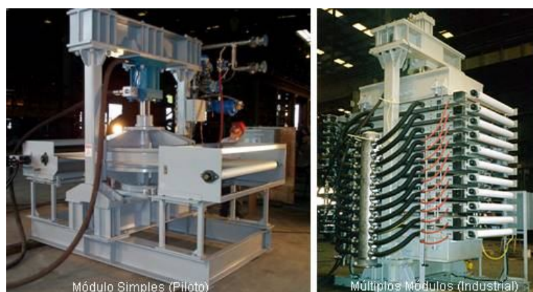
Figura 3.30 - Filtro de pressão vertical com injeção de calor (Pneumapress).
