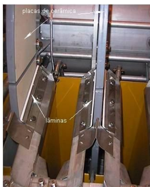
Figura 3.35 - Região de descarga das tortas em filtro de disco cerâmico (Larox Modificado). (38)
