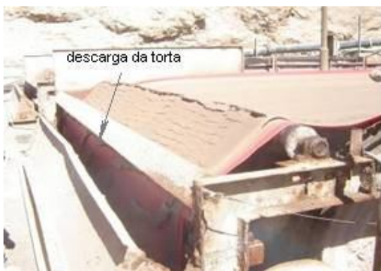
Figura 3.4 - Filtragem de rejeito de cobre em Mantos Blancos (Chile). (19)
