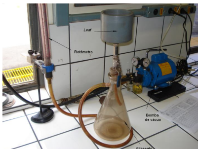
Figura 4.1 - Montagem do teste de folha ( leaf test ).
