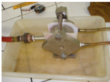
Figura 4.3 - Suporte e câmara do filtro prensa de bancada.
