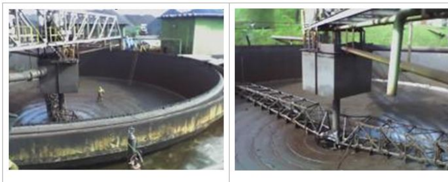
Figura 3.11 - Espessador de lamas high capacity da usina de Mutuca.
