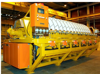
Figura 3.33 - Filtro de disco cerâmico (Larox – Ceramec). (38)
