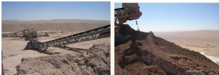
Figura 3.7 - Disposição de rejeito filtrado em Mantos Blancos (Chile). (19)
