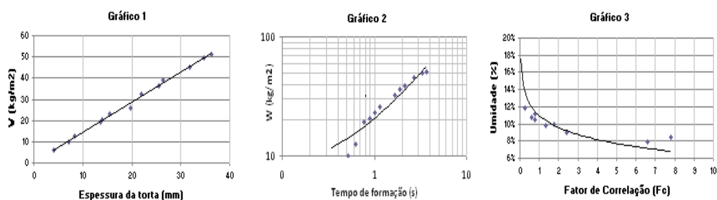
Figura 3.39 - Construção dos gráficos conforme método estabelecido por Dahlstrom e Silverblatt.
