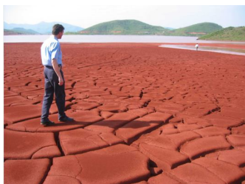
Figura 3.6 - Disposição de rejeito espessado. (20)
