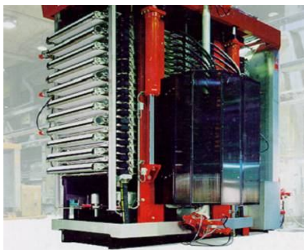
Figura 3.28 - Filtro de pressão vertical convencional (Larox).
