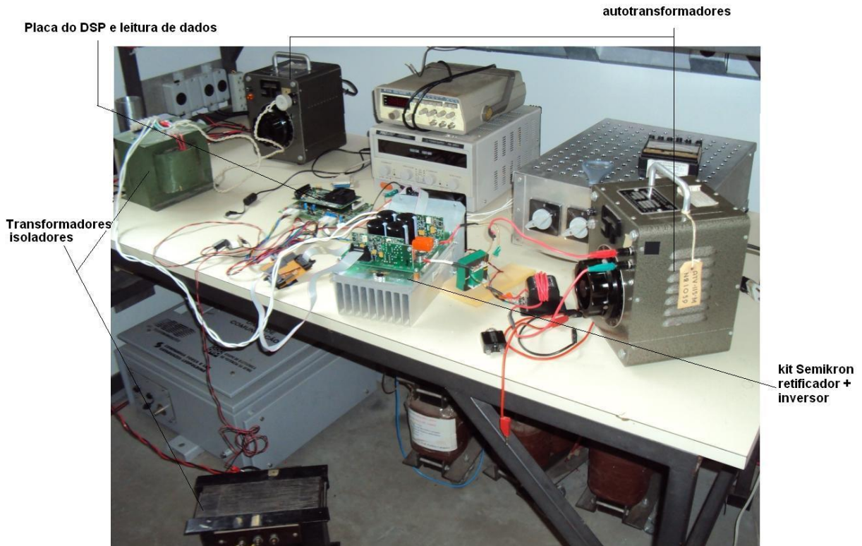
Figura 5.3 - Protótipo montado no laboratório de eletrônica de potência/UFGM.
