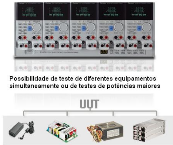
Figura 2.1 - Associação de módulos em cargas eletrônicas e equipamentos passíveis a testes. Fonte: [52].
