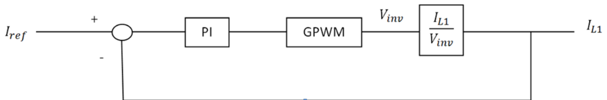
Figura 4.17 - Malha de controle para a corrente entregue à rede c.a.
