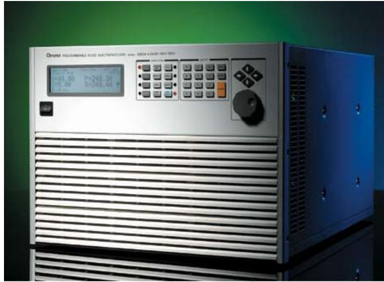
Figura 2.7 - Carga eletrônica c.a. de 4500W disponível no mercado. Fonte: [52].
