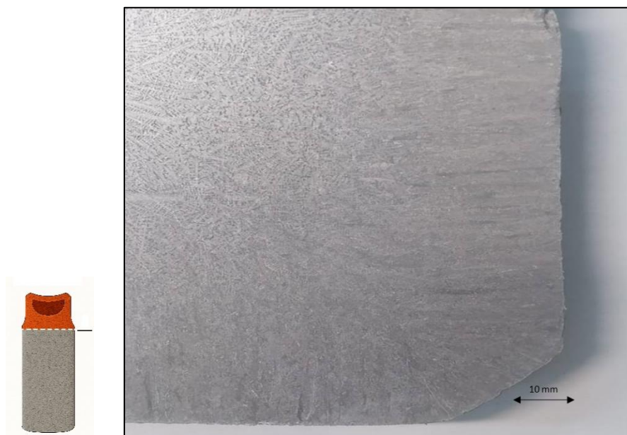
Figura 6.1.4: Detalhe do aspecto colunar nas extremidades, próximos a parede, seção transversal ao comprimento do lingote VIM.
