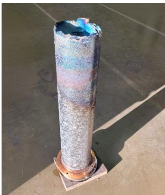
Figura 6.1.7: Lingote de aço obtido por refusão em VAR, peso aproximado de 150 kg.
