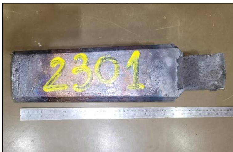
Figura 4.6.5: Lingote de liga metálica 30 kg, CIT SENAI.
