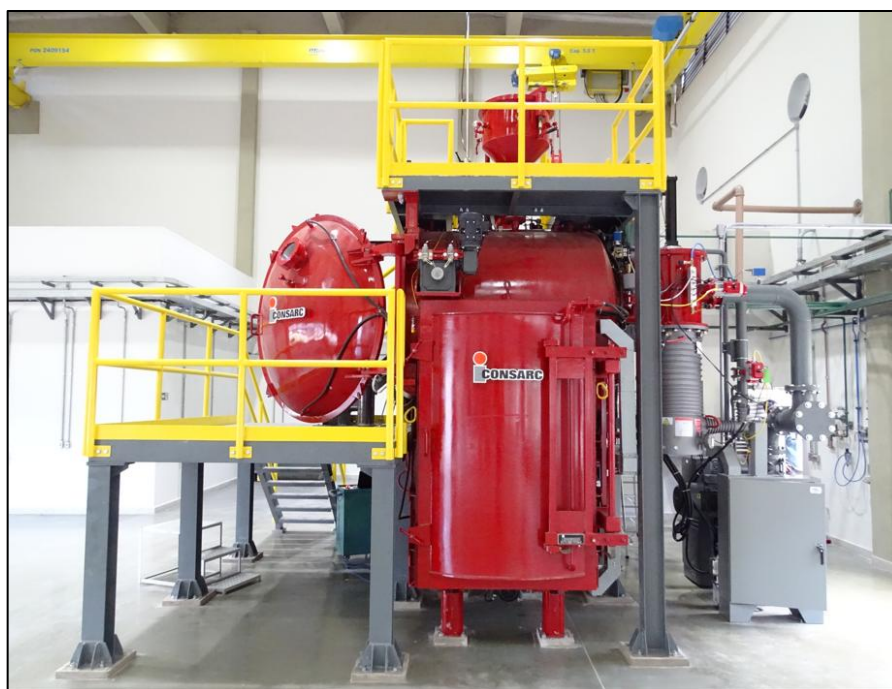
Figura 4.6.3: Forno VIM do CIT SENAI 175 kW, capacidade nominal 100 kg de aço.
