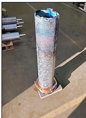
Figura 4.7.3: Lingote obtido por processo VAR no CIT SENAI.
