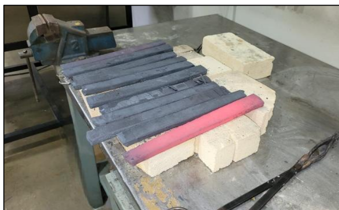
Figura 6.2.1: Aspectos das barras após laminação a quente das amostras LQVIM e LQVAR30.
