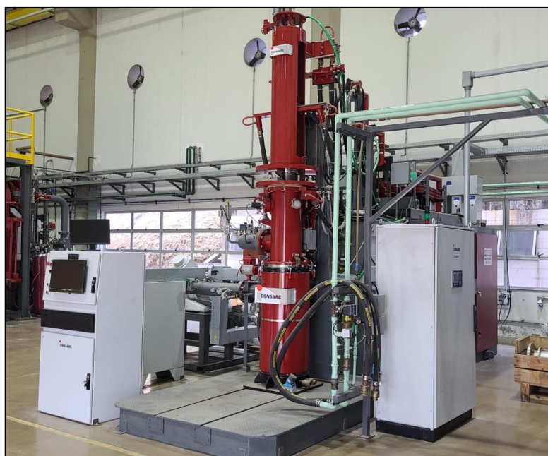
Figura 4.7.2: Forno VAR CIT SENAI capacidade 200 kg de aço.
