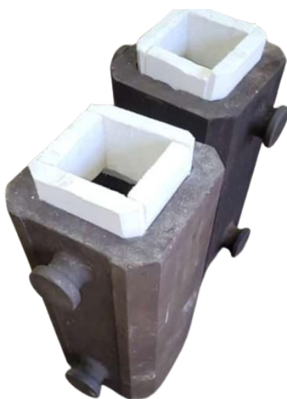
Figura 4.6.4: Lingoteiras de capacidade 50 kg de aço com “Cabeça quente”, CIT SENAI.
