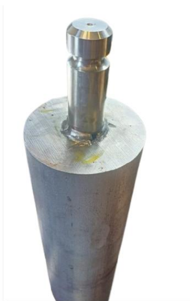
Figura 5.2.4: Aço 1020 (eletrodo) preparado para fusão em VAR. Detalhe do Stub soldado na ponta do eletrodo.
