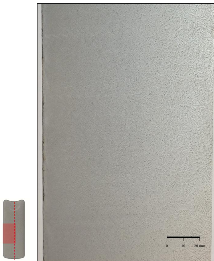
Figura 6.1.10: Macrografia na região central do lingote VAR (1/2 diâmetro), seção longitudinal ao comprimento do lingote.
