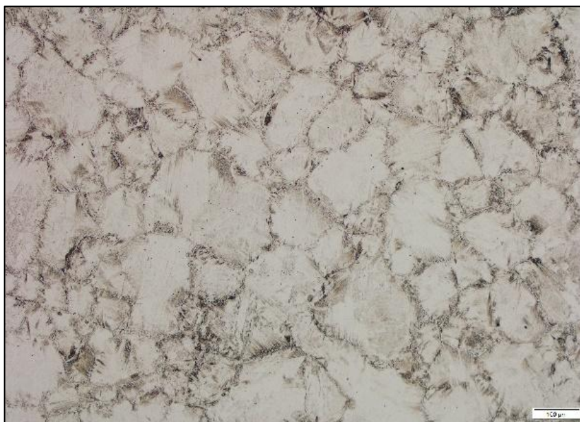
Figura 6.1.13: Amostra VAR inserida em forno a 1200°C por 30 minutos e temperada em salmoura, ataque com solução saturada de ácido pícrico.
