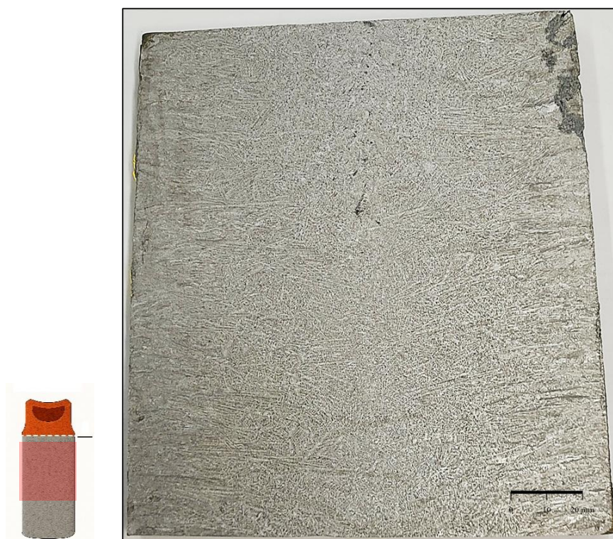
Figura 6.1.5: Macrografia da seção longitudinal ao comprimento do lingote VIM, presença de alguns poros na região próxima à região da cabeça quente.
