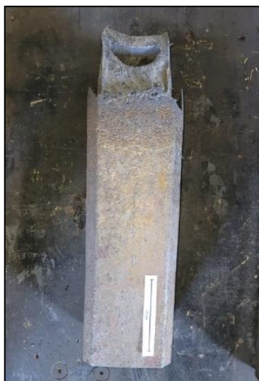
Figura 6.1.1: Lingote de aço 50 kg obtido por fusão em VIM.
