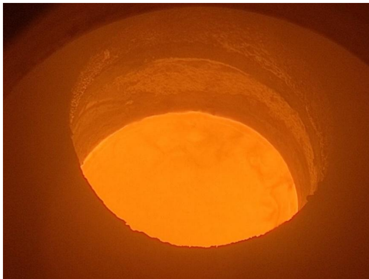
Figura 5.2.2: Aspecto do aço SAE1020 líquido a 1580°C sob atmosfera de argônio.
