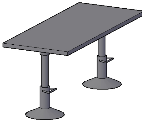
FIGURA 4- Bancada regulável, com 2 pistões adaptados
