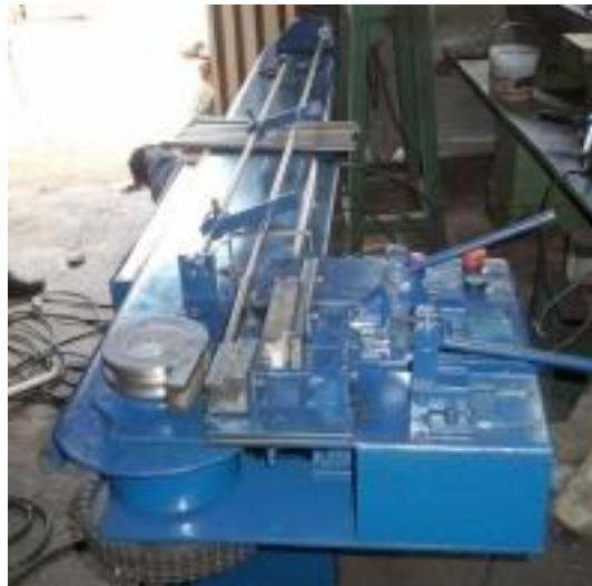
FIGURA 8- Dobradeira de tubos pneumática automática fabricada por encomenda de acordo com as especificações do cliente.
