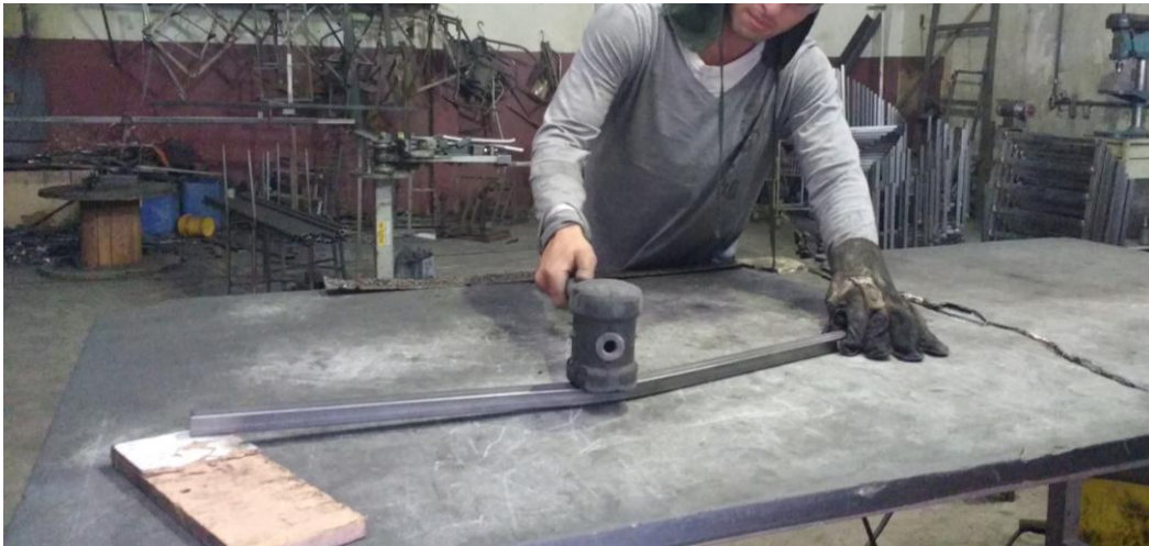
FIGURA 3 – Uso da marreta para realizar o acerto na angulação da peça.
