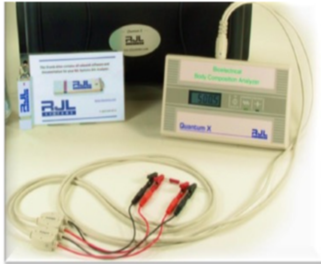
Figura 3. Aparelho de Bioimpedância Elétrica Quantum X RJL System (Fonte: RJL System, 2007).
