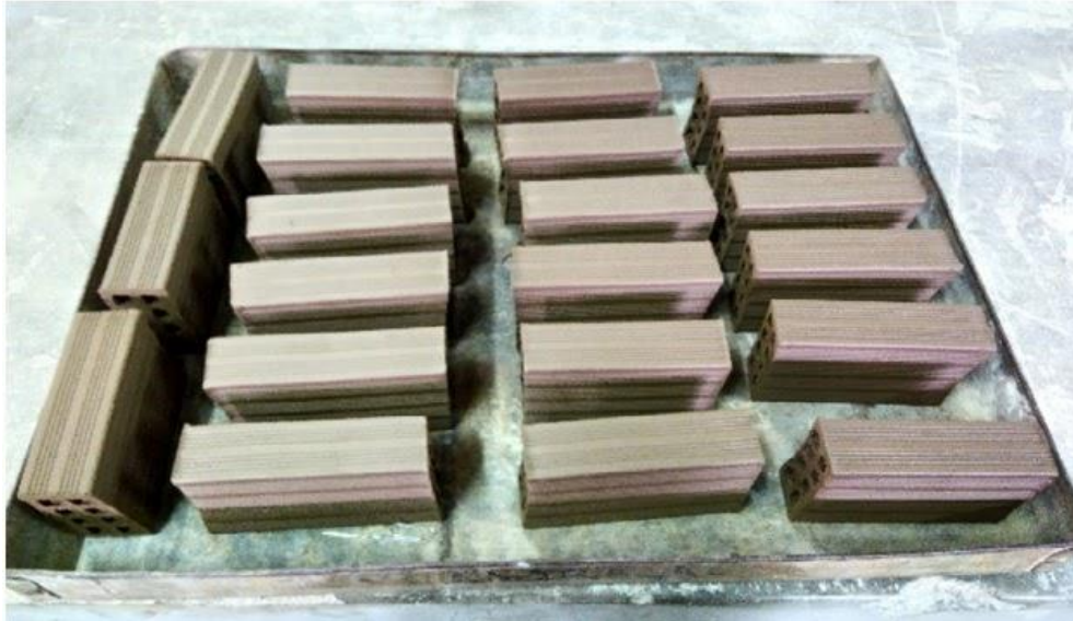
Figura 5.4 - Tijolos produzidos com RMF, argilas amarelas e cinzas, antes da queima
