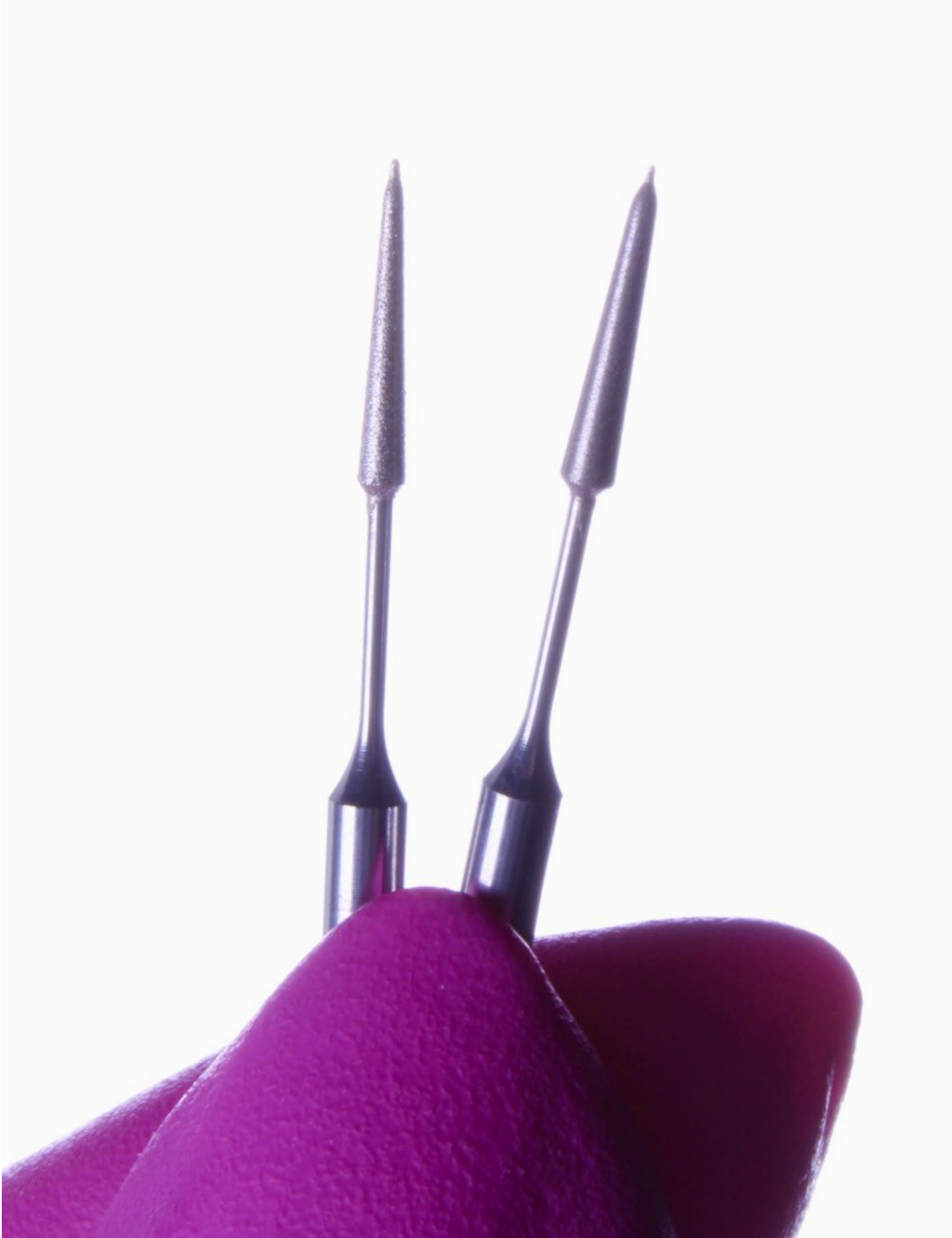
Figura 6 Pontas adiantadas experimentais com formato tronco-cônico, granulometria de 15 micrômetros e diâmetro cervical de 1,4 e 1,6 mm respectivamente
