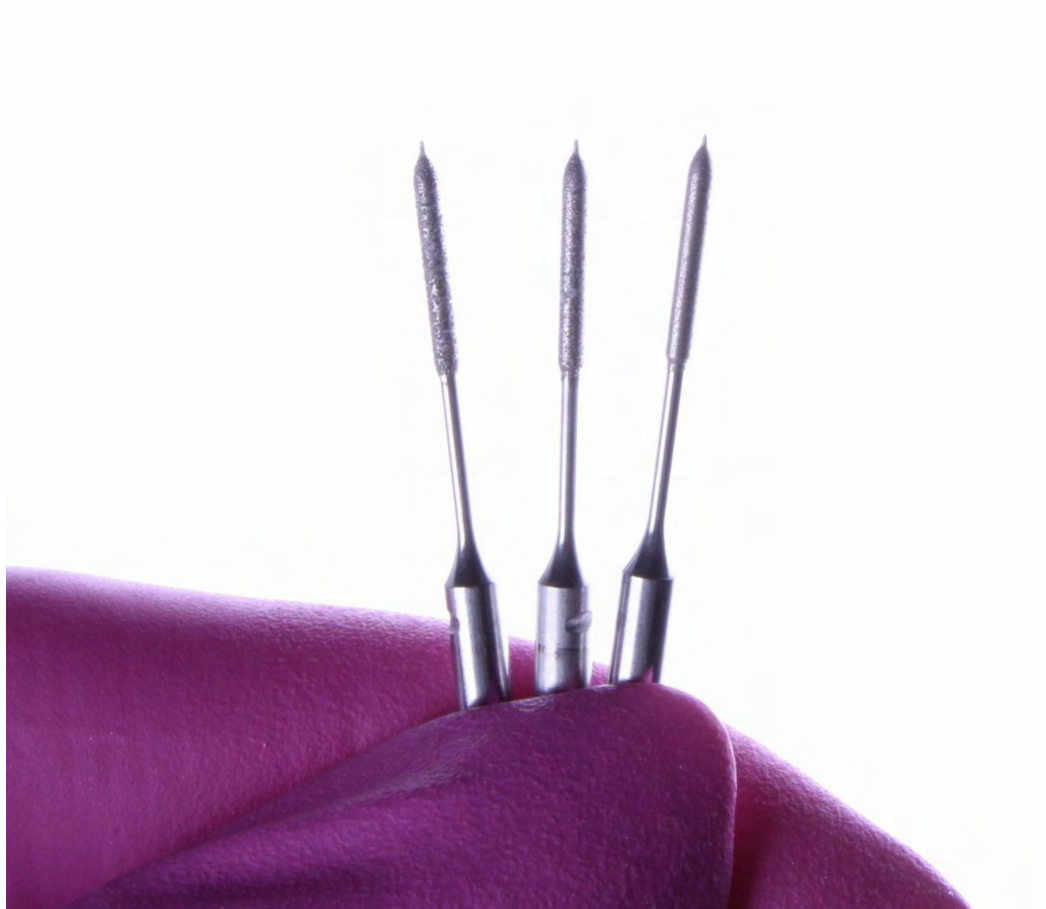
Figura 2 Pontas experimentais adiantadas cilíndricas com granulometrias de 45, 30 e 15 micrômetros, respectivamente
