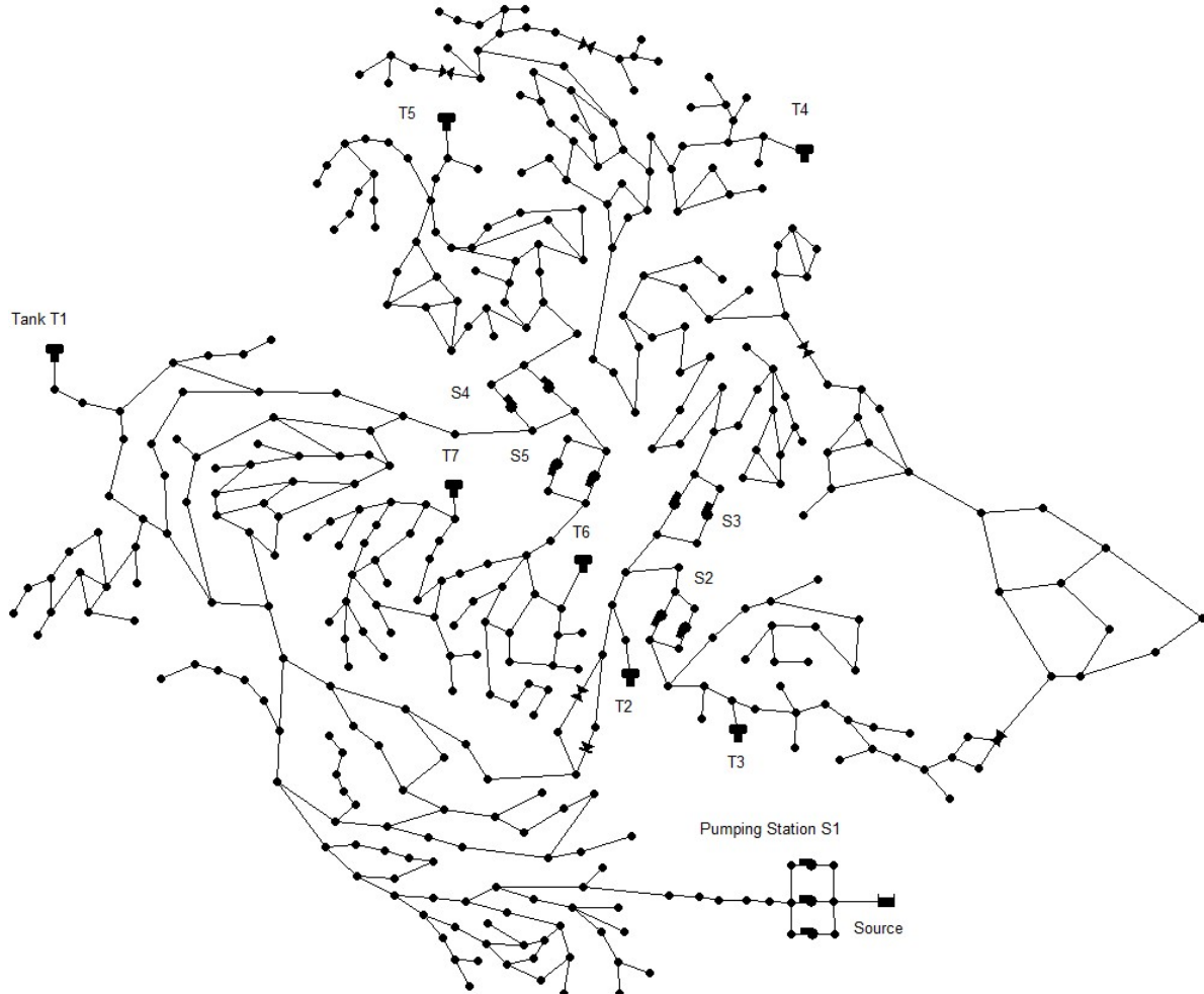
Figura 4.4 – Rede de distribuição de água D-Town
