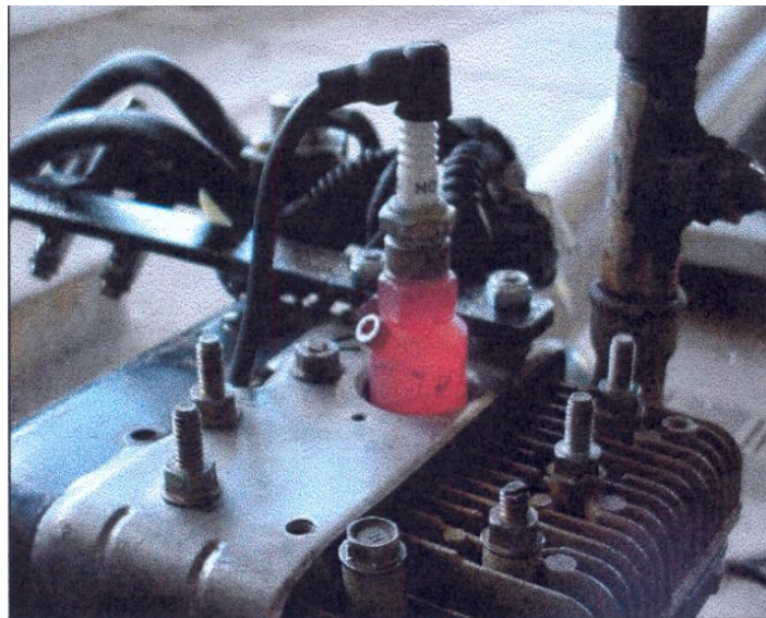
Figura 2.28 Aquecimento excessivo da pré-câmara desprovida de sistema de refrigeração, SÁ (2001).
