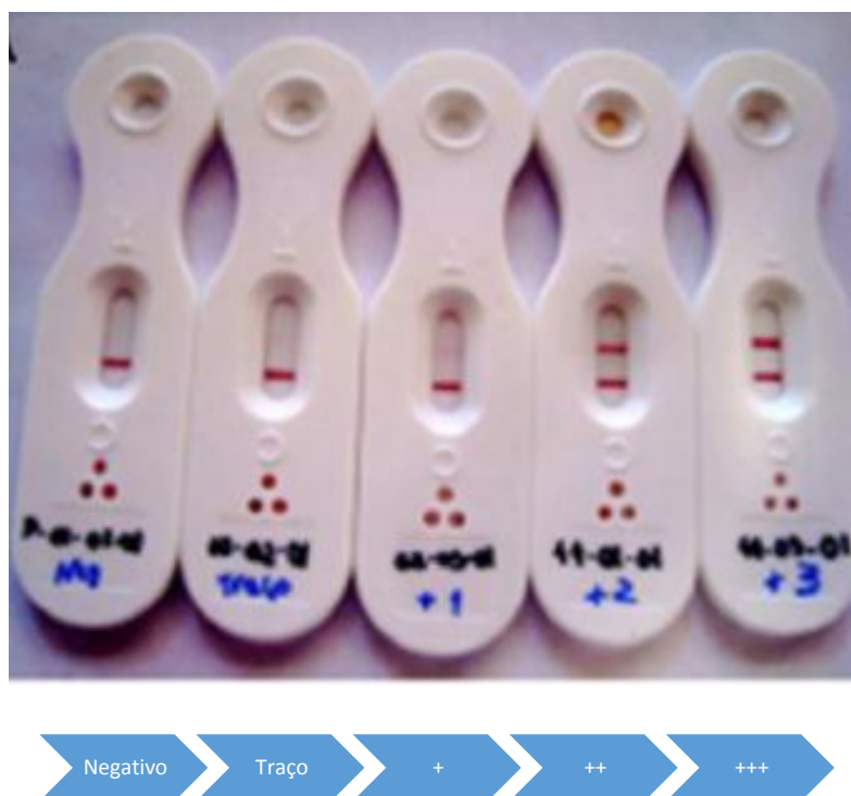
Figura 7 - Classificações do Teste Rápido de Urina (POC-CCA®). Os números superiores (cor negra) referem-se à identificação do paciente e os inferiores (cor azul) a classificação do resultado. Pontuações visuais variaram de negativo a traço, fraco (+), moderado (++) e fortemente positivo (+++)
