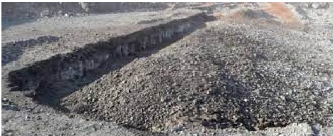
Figura 17: Fragmentação e desmonte Minério de Ferro
