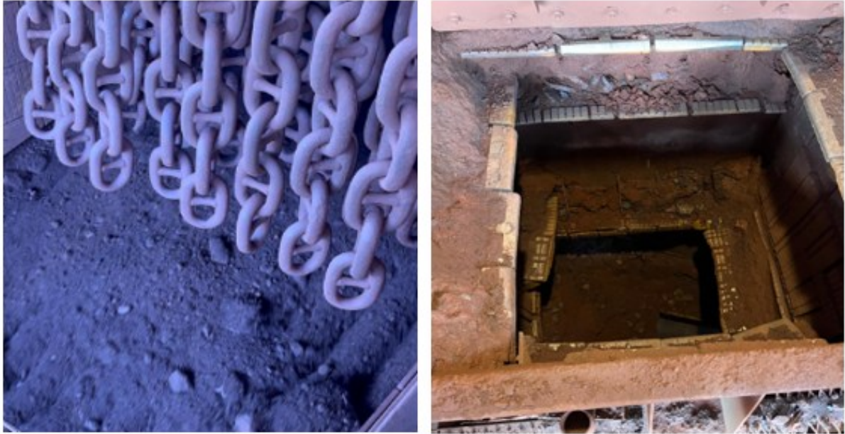
Figura 18: Chute de transferência para minério de ferro
