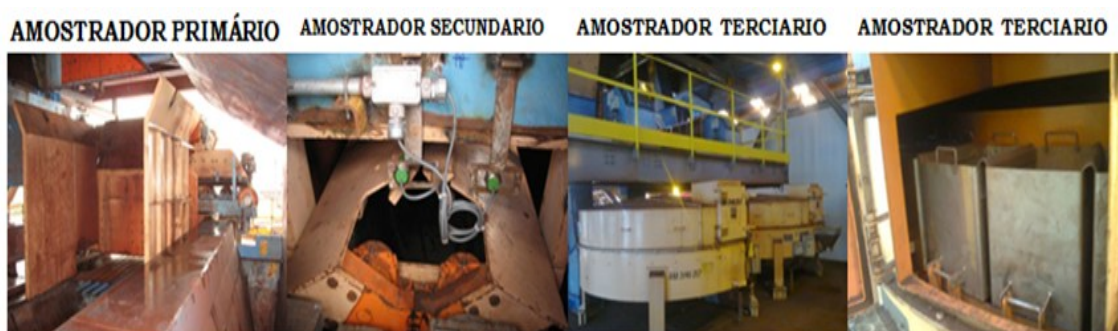
Figura 34: Circuito de amostragem para análise granulo química
