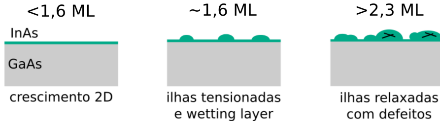
Figura 2.2 – Diagrama esquemático do modo de crescimento Stranski-Krastanov em QD de InAs crescidos sobre GaAs, desde a formação de uma heteroestrutura bidimensional ao aparecimento de defeitos, devido à quantidade de material nominal depositado.
