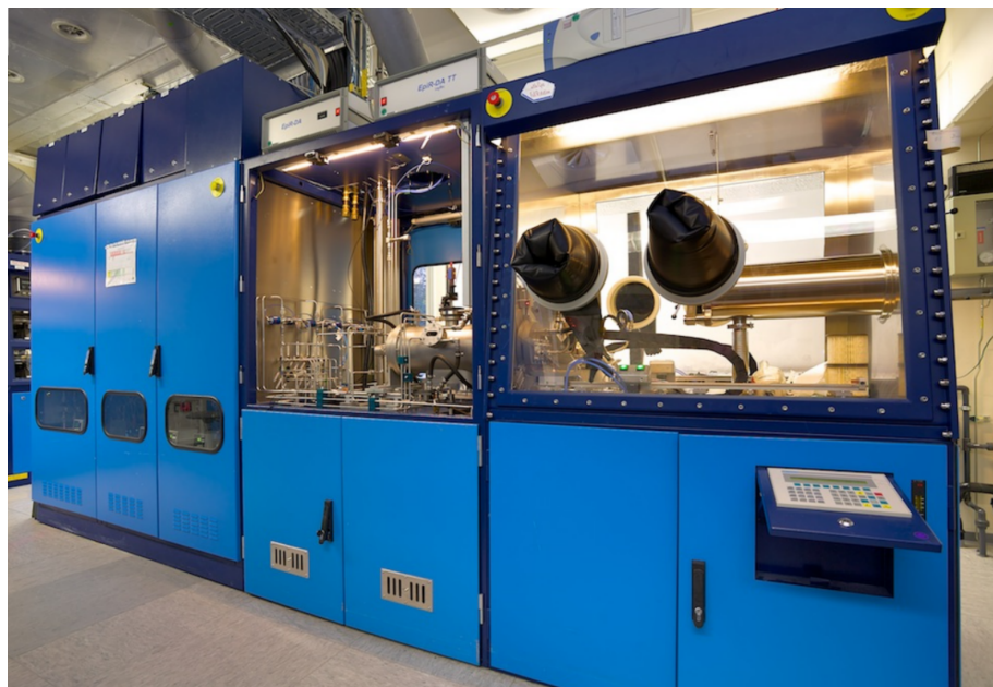
Figura 3.2 – Foto do sistema para deposição química de metalorgânicos em fase vapor (MOVPE) modelo Aixtron AIX-200 semelhante ao encontrado no LabSem, PUC-Rio.
