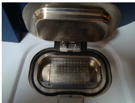
Figura IV.4. Placa MALDI-TOF no compartimento do equipamento de espectrometria de massas Bruker Daltonik Microflex LT.
