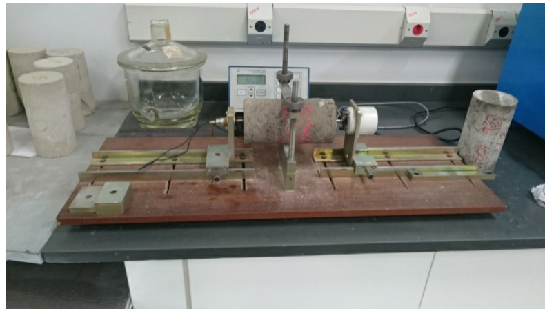
Figura 4.6 - Equipamento para o ensaio de módulo de elasticidade dinâmico
