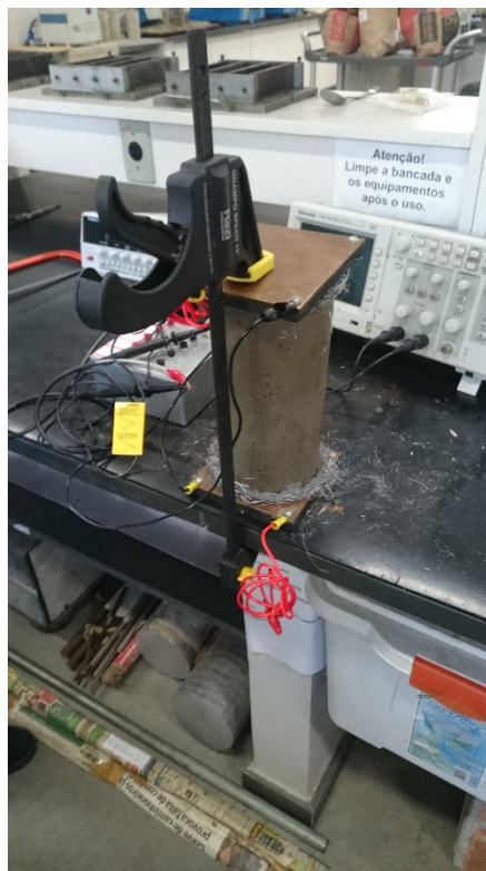
Figura 4.7 - Equipamento para o ensaio de resistividade elétrica
