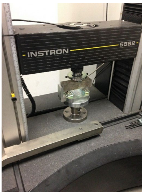
Figura 4.5 - Equipamento para ensaio de resistência mecânica à tração na flexão.
