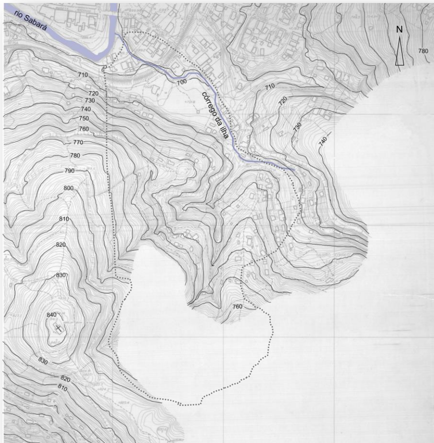
Imagem 70 - Levantamento topográfico no bairro Córrego da Ilha, na década de 1970.
