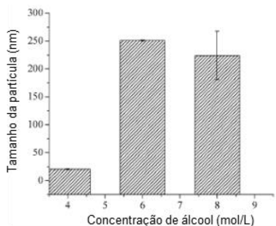
Figura 3.16 – Relação entre o tamanho médio das partículas de sílica formadas e a concentração de álcool na reação. (adaptado de RAO et al. , 2005)
