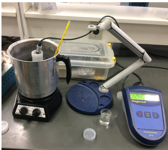
Figura 4.4 – Ensaio de variação de condutividade elétrica
