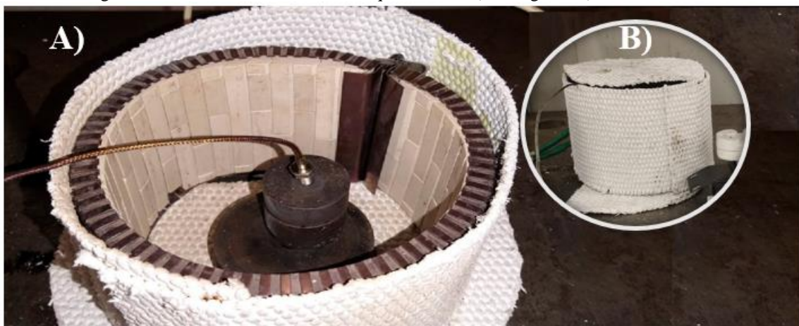
Figura 4.15 - Detalhes do sistema de aquecimento: a) vista geral; b) sistema isolado.
