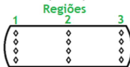
Figura 5.6 – Endentações na seção transversal do anel
