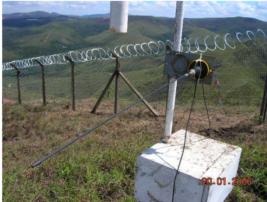
Figura 3.11 – Antenas de medição de variações lenta e rápida de campo elétrico.
