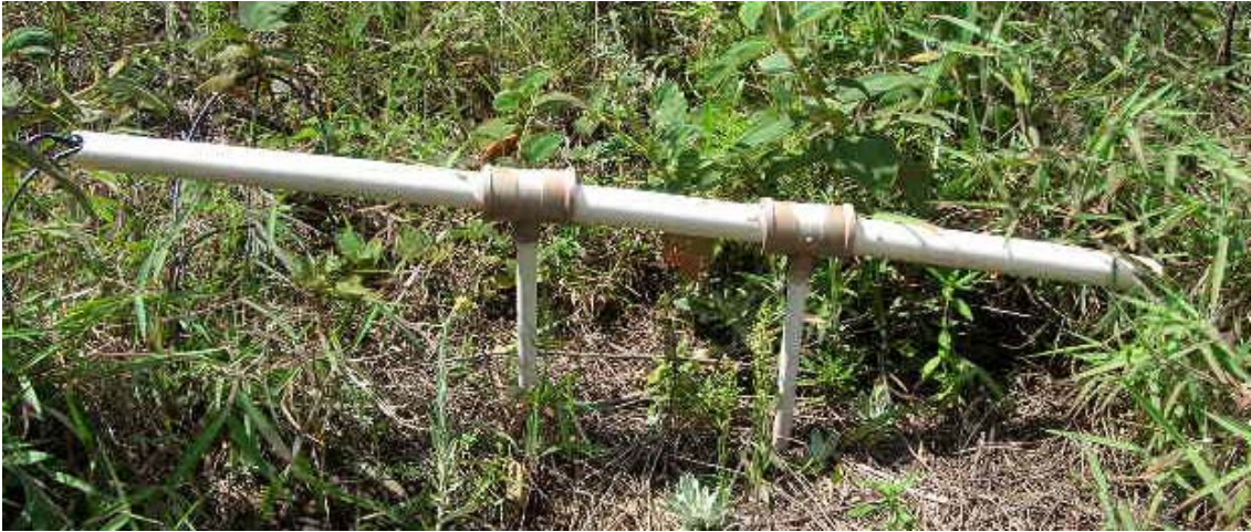
Figura 3.17 – Montagem do divisor de tensão do loop .
