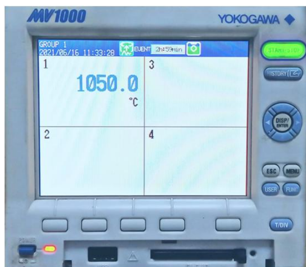
Figura 4.8 - Registrador de dados usado na medição das temperaturas de têmpera e revenimento das amostras.
