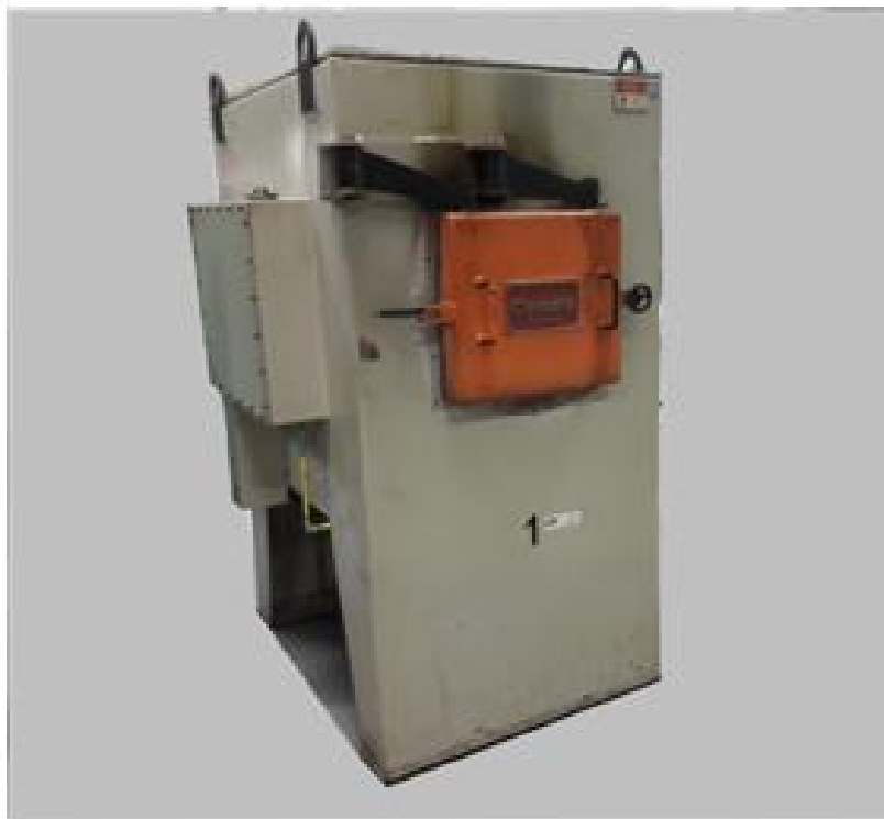
Figura 4.4 - Forno resistivo Combustol usado na austenitização das amostras.
