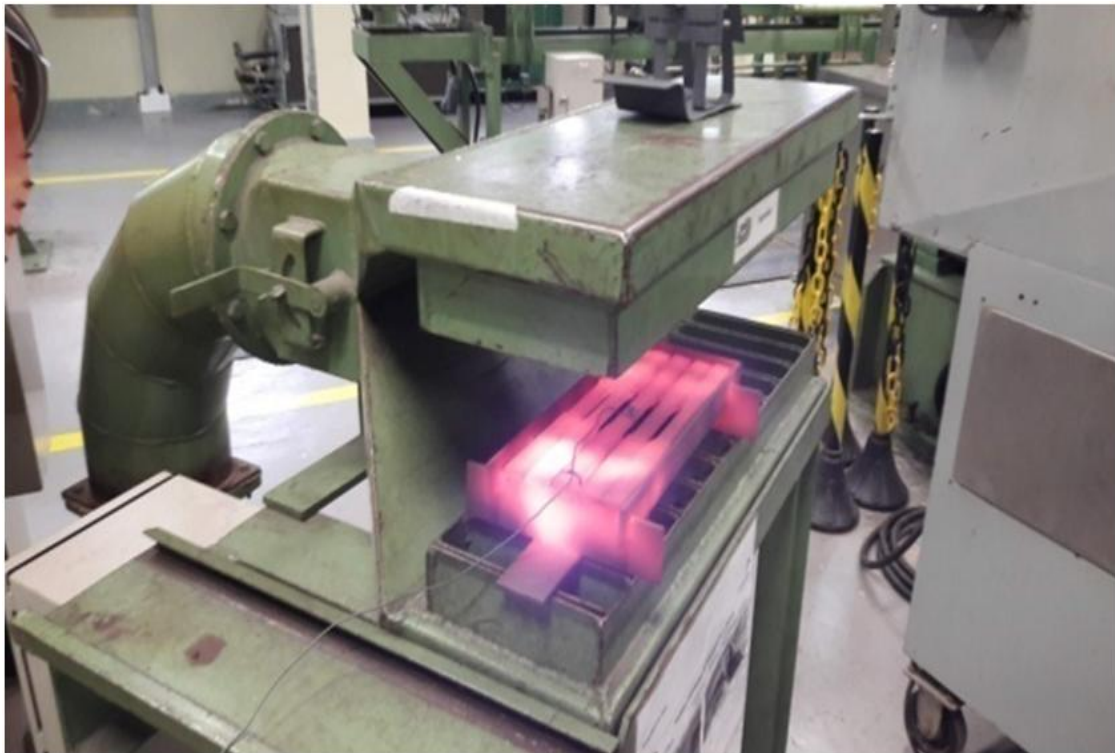
Figura 4.6 - Ciclone de ar forçado usado na têmpera das amostras.
