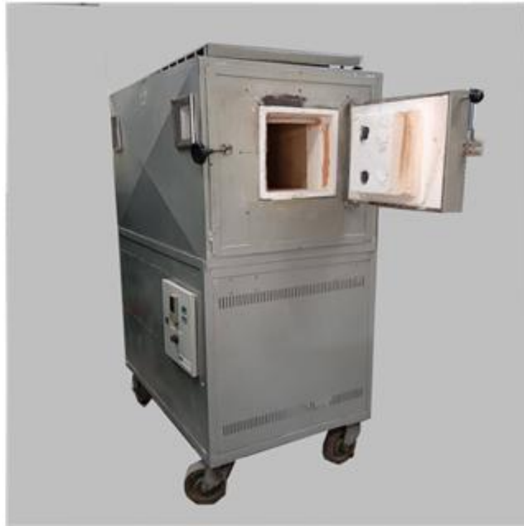
Figura 4.7 - Forno resistivo, usado nos tratamentos térmicos de revenimento.
