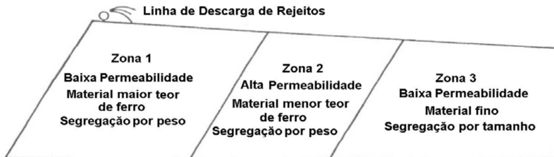
Figura 3.16 – Modelo teórico de variação da condutividade hidráulica esperado para o empilhamento drenado do Monjolo (SANTOS, 2004).
