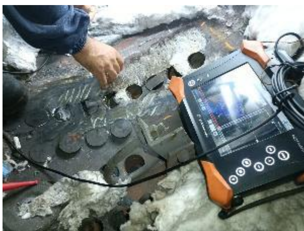
Figura 17 – Realização do ensaio por ultrassom phased array.
