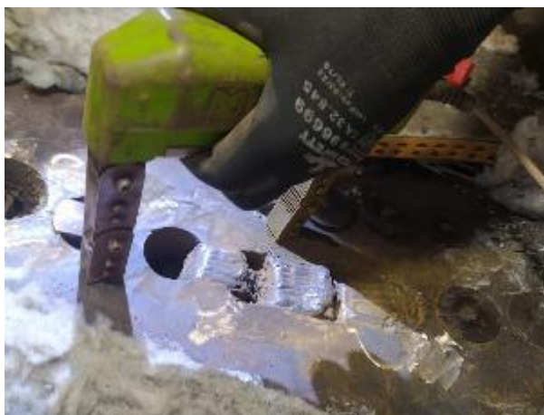
Figura 16 – Realização do ensaio por partícula magnética.
